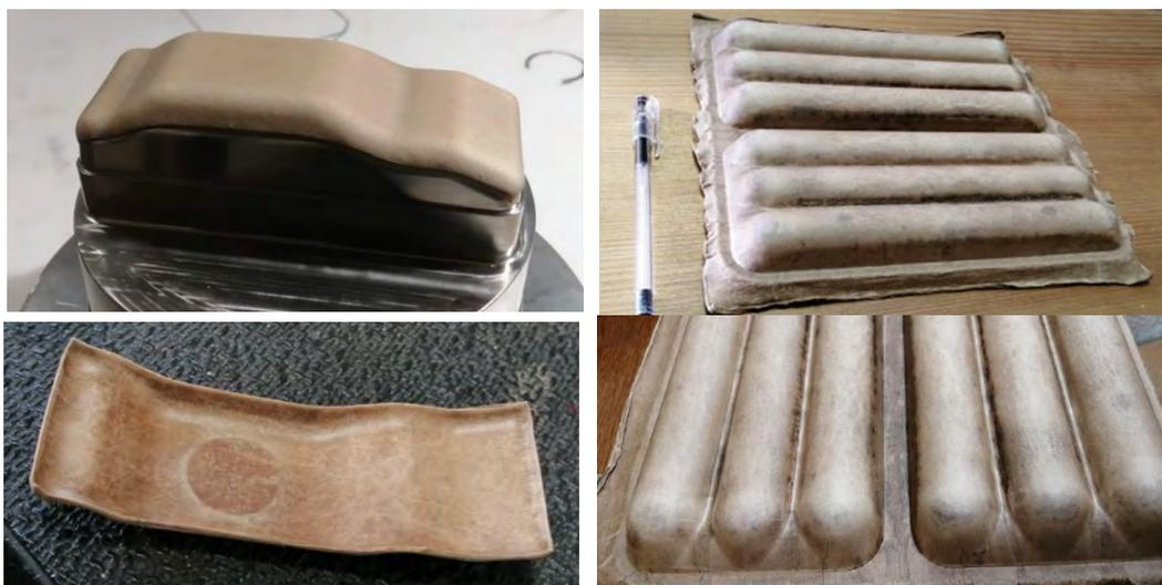
図 [3]-7-3 三次元成型体の試作例
