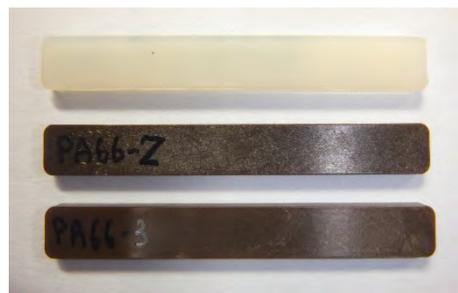
図[3]-1-43 CNF/PA66 の射出成形品の外観
