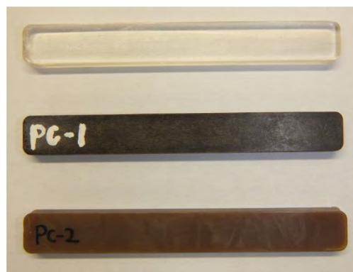
図[3]-1-37 CNF/PC の射出成形品の外観
