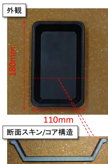
図[3]-3-6 スケールアップ成形品（トレイ）の外観及び断面
