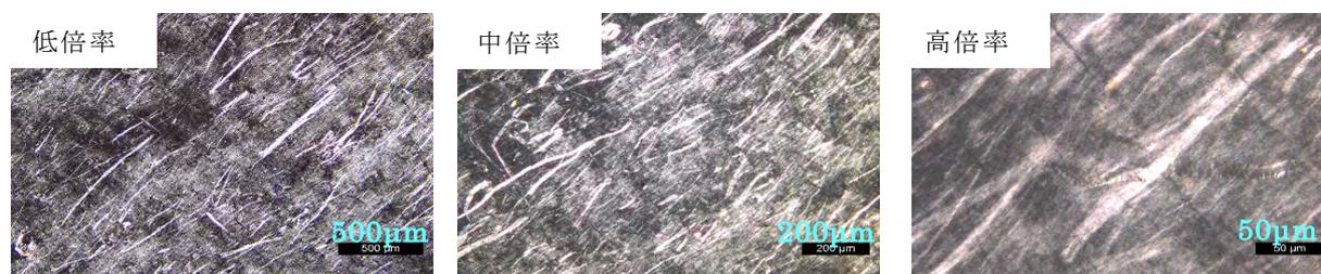
図[3]-1-80 大量生産変性パルプ 10%強化 PP 材料の分散 CNF の偏光顕微鏡写真
