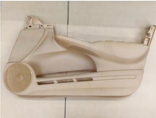
図[5]-2-3 ドアトリム成形品 (CNF・PP 射出成形)
