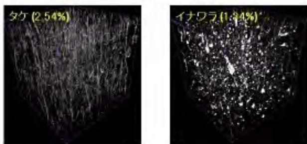
図[1]-2-3 樹脂中での変性パルプの解繊状態
