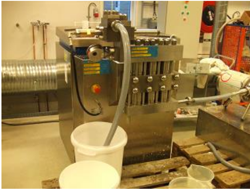
高圧ホモジナイザーSPX社製(デンマーク) 処理量:200g/hで濃度1%
