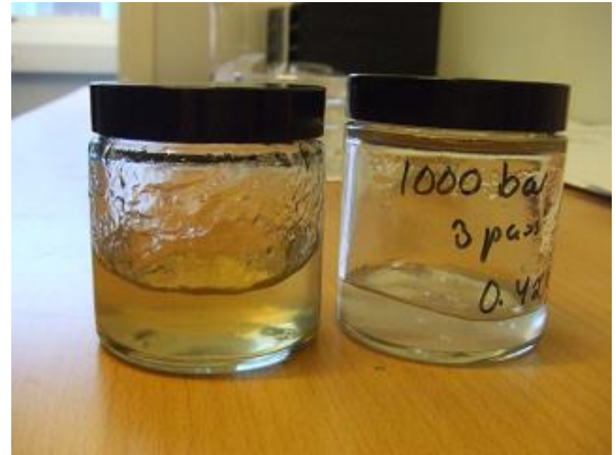
CM化CNF(ホモジナイザー) 左:未漂白、右:漂白パルプを使用 濃度;0.46%、3パス、1000Bar、透明/ゼリー状
