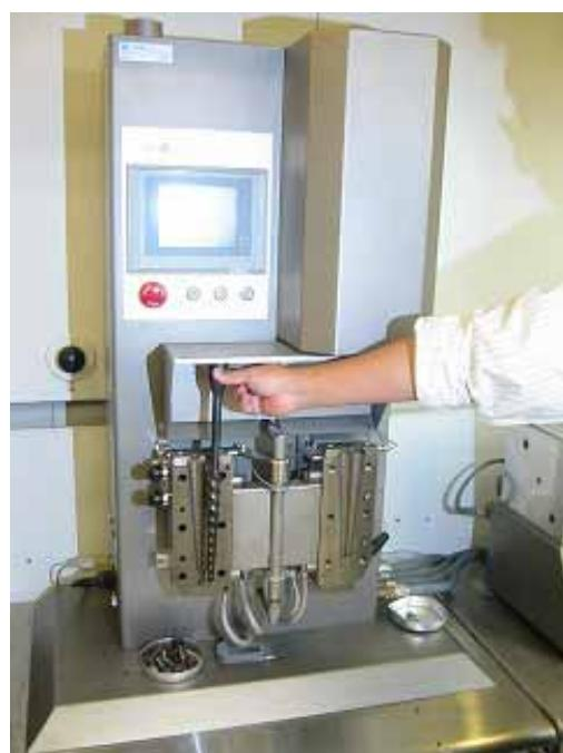
写真2 熱可塑性樹脂へのナノファイバー分散のための循環式2軸押出し機(DSM社製)
