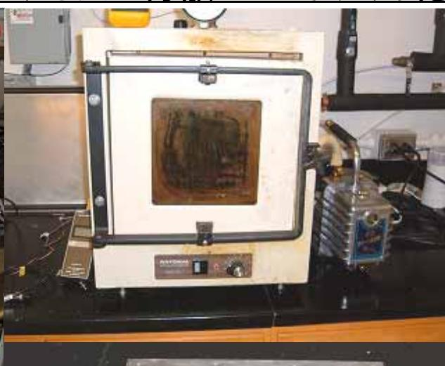
真空脱泡、金型へ注型
