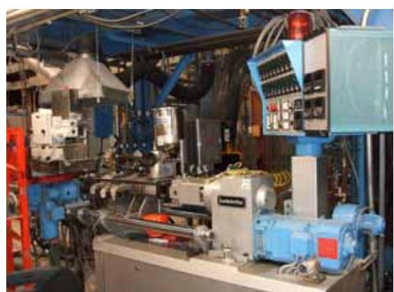
写真 5 直交フィーダー付2軸混練機
