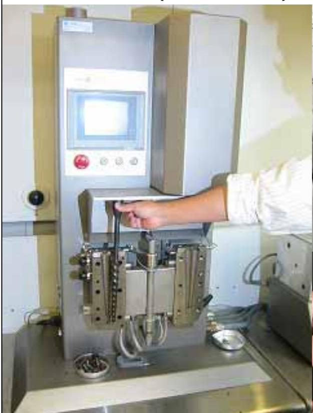
循環式2軸押し出し機
