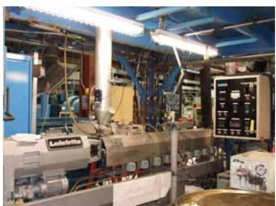
写真 4 軸径 45 の2軸混練機
