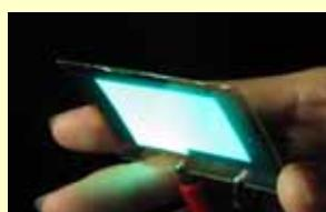
バイオナノファイバー複合材料を透明基板に用いた有機EL素子
