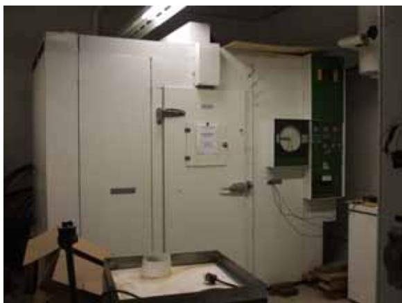
写真 1 大型の熱変形試験装置
