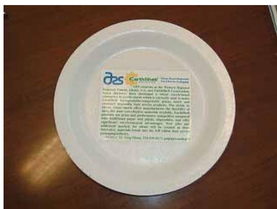
写真 1 澱粉マトリックス生分解性複合材プレート
