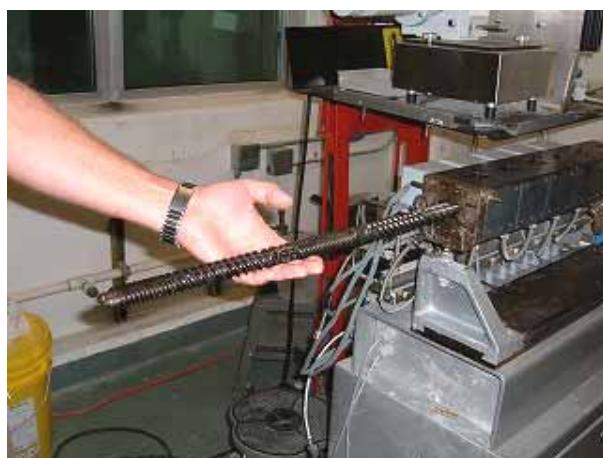
写真 3 ナノフィラー分散用小型 2 軸押し出し機
