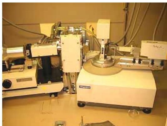
写真3 結晶構造解析用 X 線回折装置
