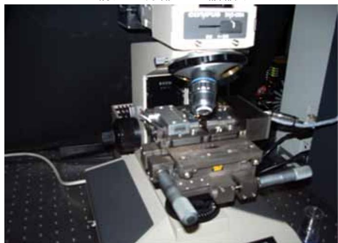
写真 3 引張りステージ付属ラマン散乱装置
