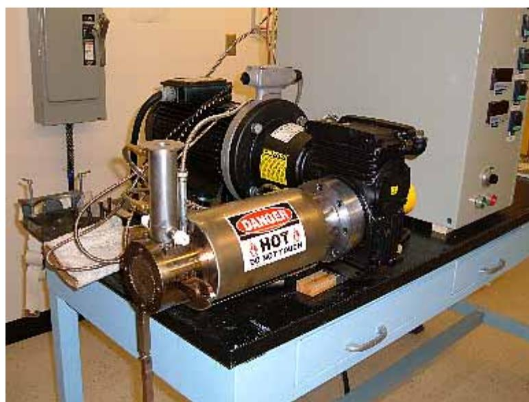
写真 8 複合材料成形用の押出機
