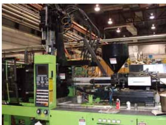
写真 6 型締圧 120tの射出成形機
