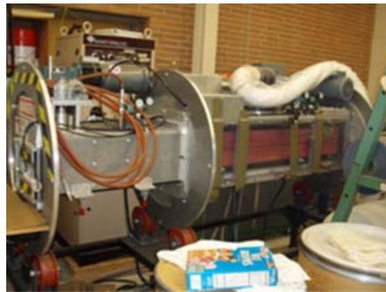
写真 8 実験室の Extruder
