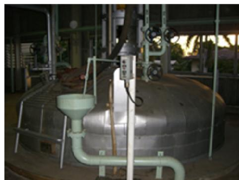
写真5 エタノール製造プラントの発酵タンク
