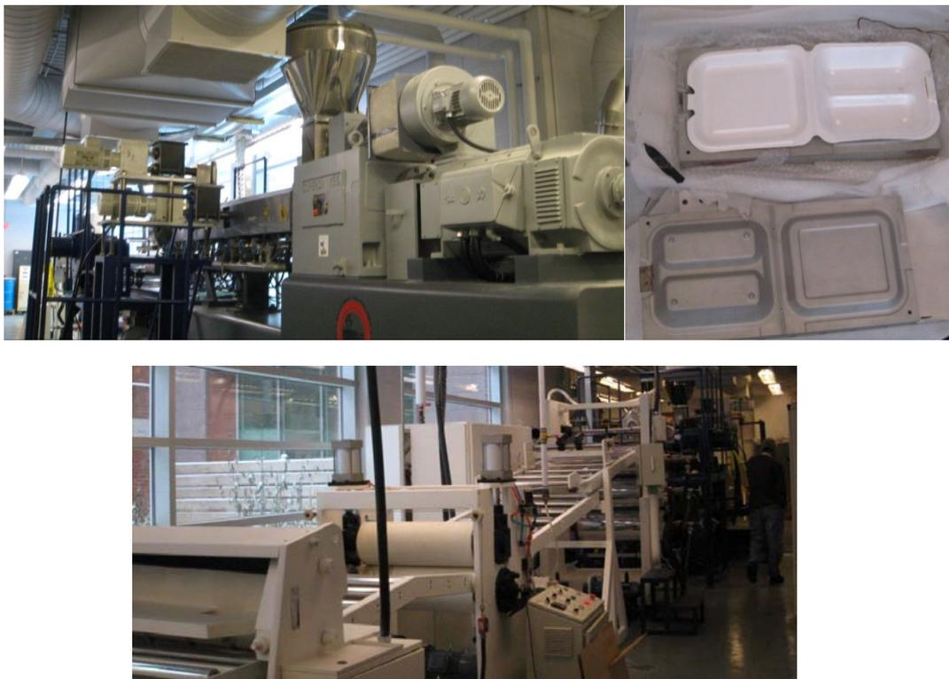
写真8 小規模プラントスケール射出成型機（左上）、発泡食品トレイとその金型（右上）
