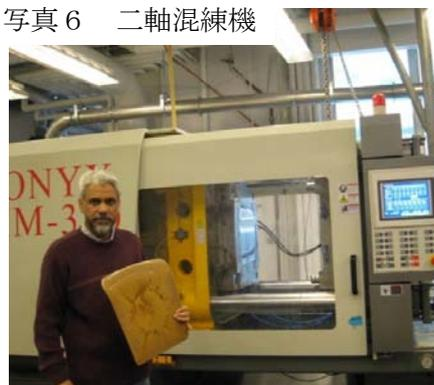
7 Injection molding machine とその成型物 (椅子の座面)
