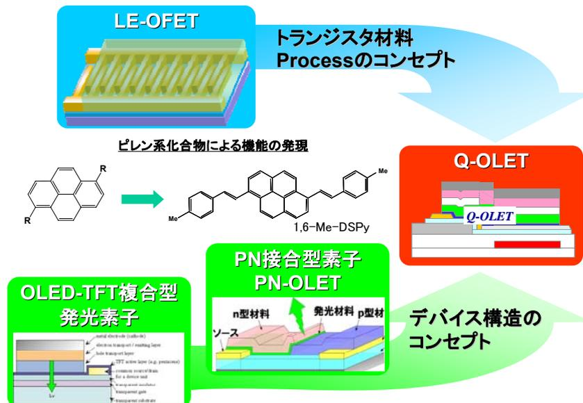
図 1.2-1 有機発光トランジスタ構造の変遷
