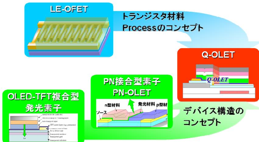
図1.2 有機発光トランジスタ構造の変遷
