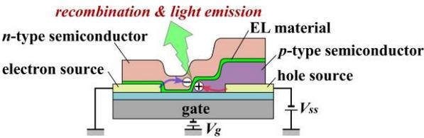
図 2. (2.2).1: PN-OLET 構造の概念図
