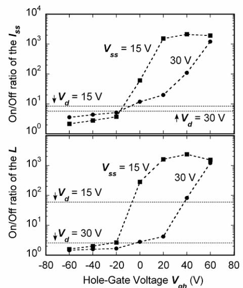
図 2.(2.2).8: On/Off 比のホールゲート電圧依存性
