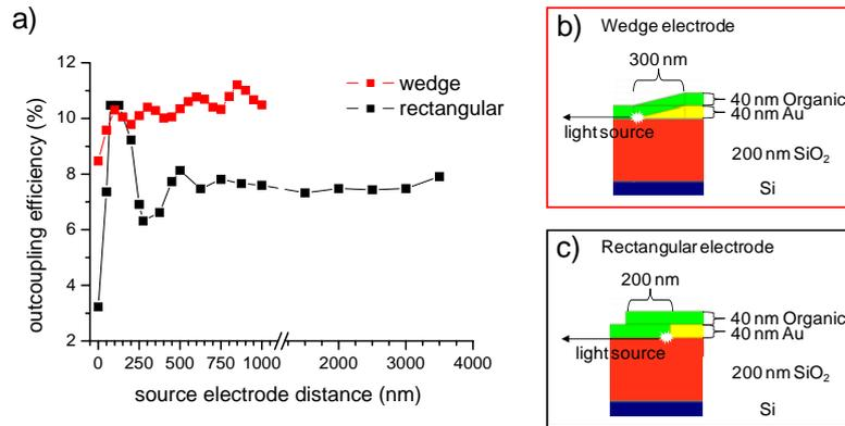
図 2.(2.1).11 (a)電極形状の与える光取り出し効率への影響、(b)くさび形電極構造、(c)直角型電極構造
