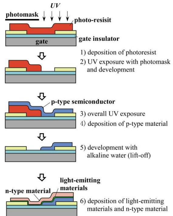
図 2.(2.2).2: 有機薄膜のパターニングプロセス
