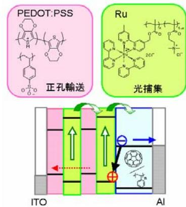
図 3.3. 機能複合膜の素子構造
