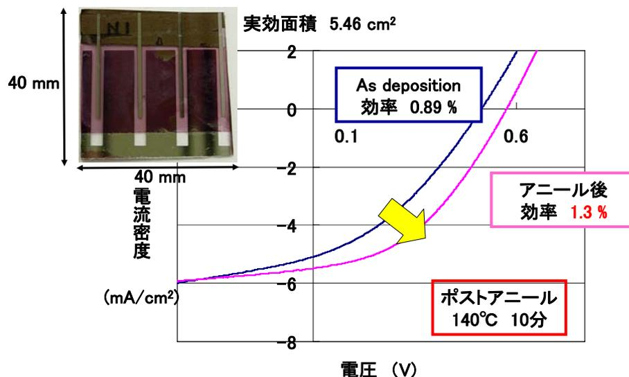
図2. 5. 13. 40mm×40mm ガラス基板での測定結果
