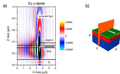
図 2. (2.1).9 (a) y 軸方向での光放射強度の分布の計算結果と電極や発光点との関係(b)のオレンジの面で切断した。
