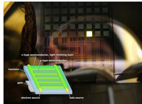
図 2.(2.2).3: 発光の様子と発光面の概念図
