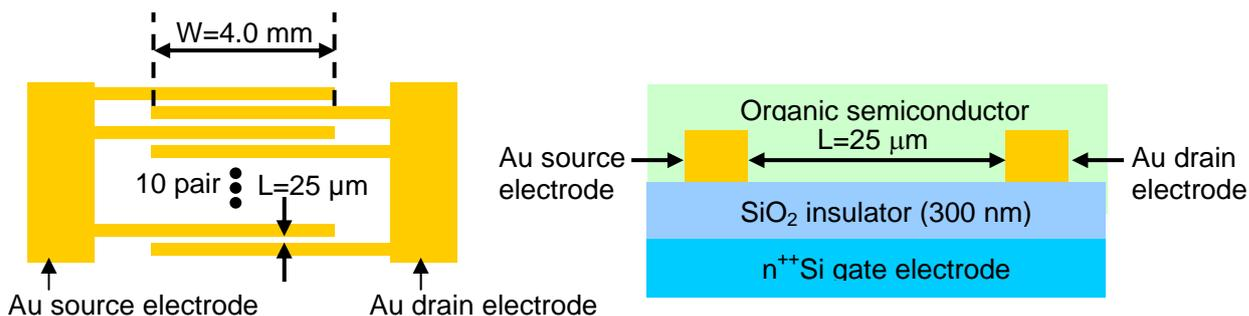
図 2. (2.1) 1 評価に用いたトランジスタの構造
