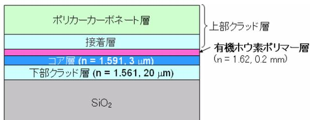
図 2.4.11 単層導波路媒体の構造
