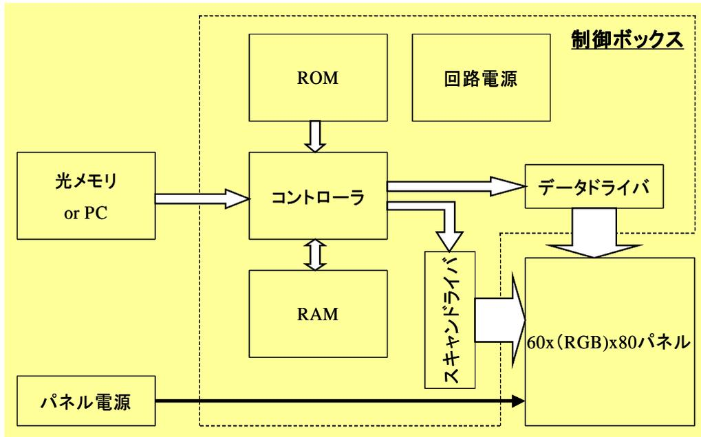
図 2. 5. 15 制御ボックスのブロック図
