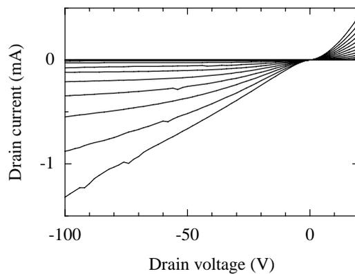
図 2.(2.2).10 ポリイミド絶縁膜を用いたペンタセントランジスタの
