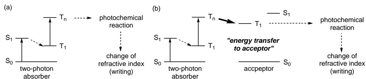
図2.4.1 二段階光反応のスキーム
