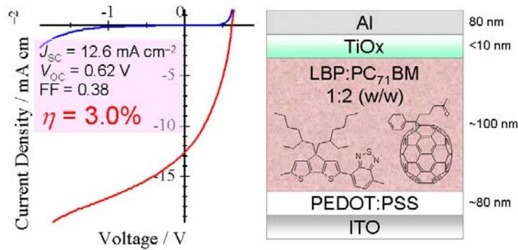
図 1.2-2. LBP/PC<sub>71</sub>BM バルクヘテロ接合素子の素子特性と構造
