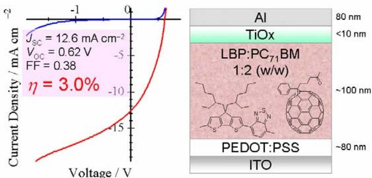
図 3.9. LBP/PC<sub>71</sub>BM バルクヘテロ接合素子の素子特性と構造
