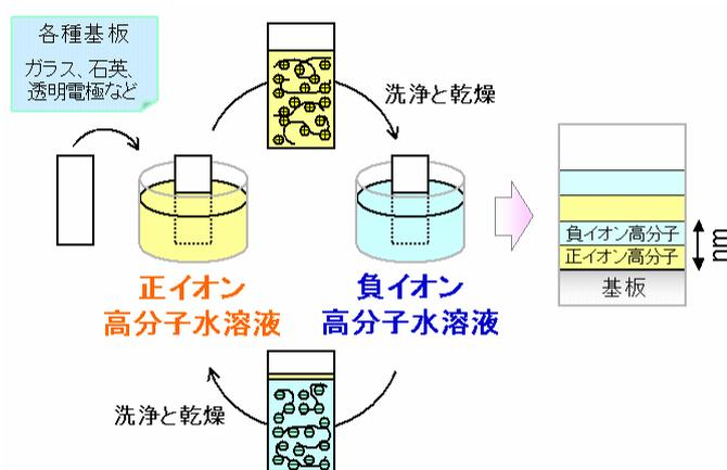
図 3.2. 交互吸着膜の作製工程
