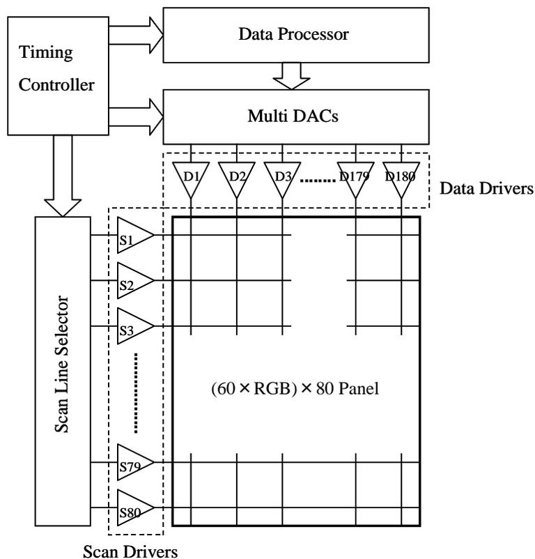
図 2. 5. 19. 駆動回路の全体ブロック図
