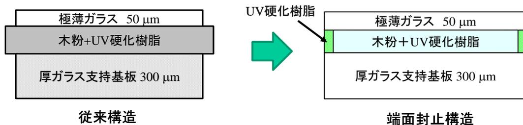
図2. 5. 7. バイオナノファイバーコンポジット基板
