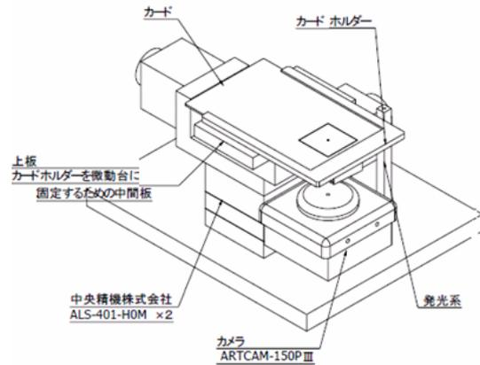
図2. 5. 11. 試作ドライブ装置(一括光再生方式、サイズ:150X100X100mm<sup>3</sup>)
