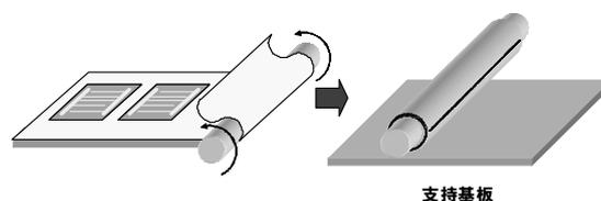
図 2.(2.2).11 『Plate to Roll』法の概略図
