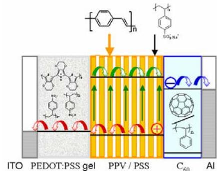
図 3.4. PN 接合素子の素子構造
