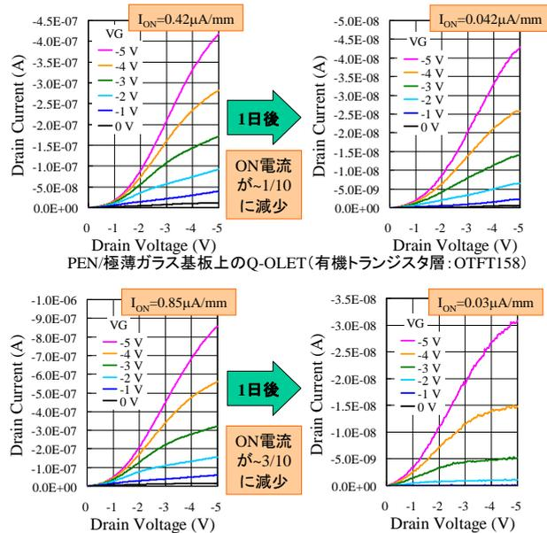
木粉/極薄ガラス基板上のQ-OLET(有機トランジスタ層:OTFT158)
