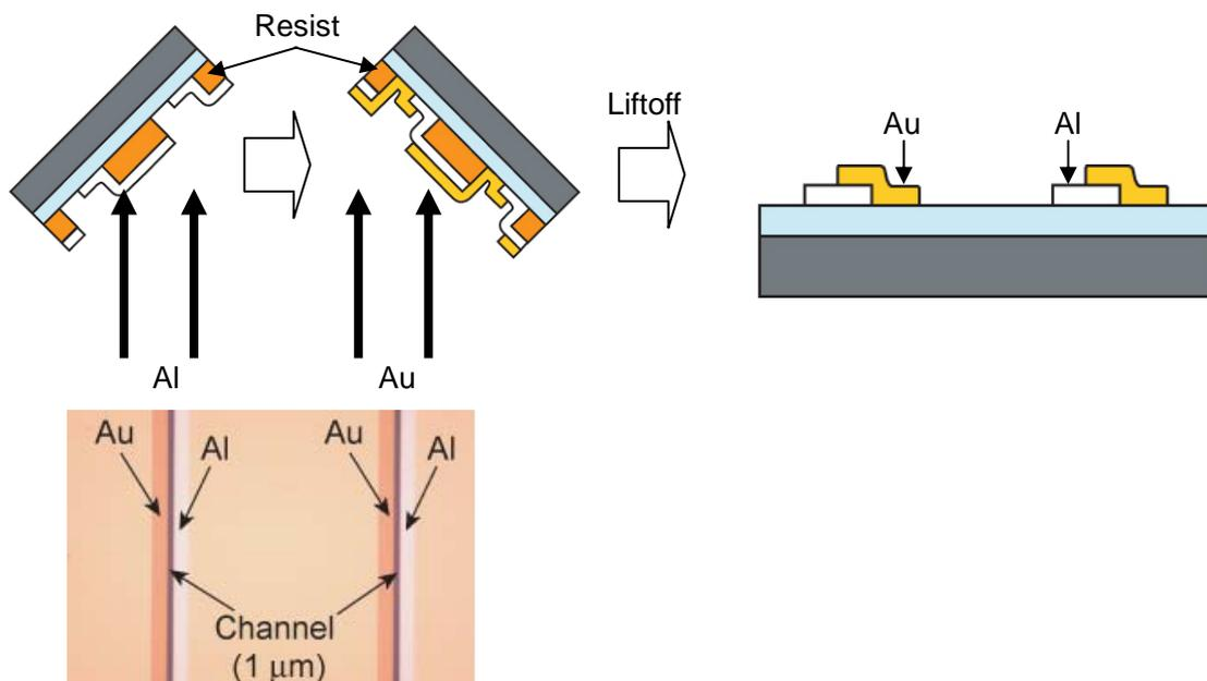
図 2.(2.1).4 対称電極の作製法と顕微鏡写真
