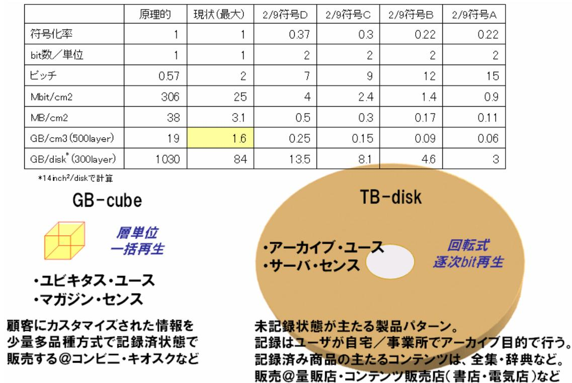
図2. 5. 22. 媒体の将来イメージ(形状、容量、使われ方)
