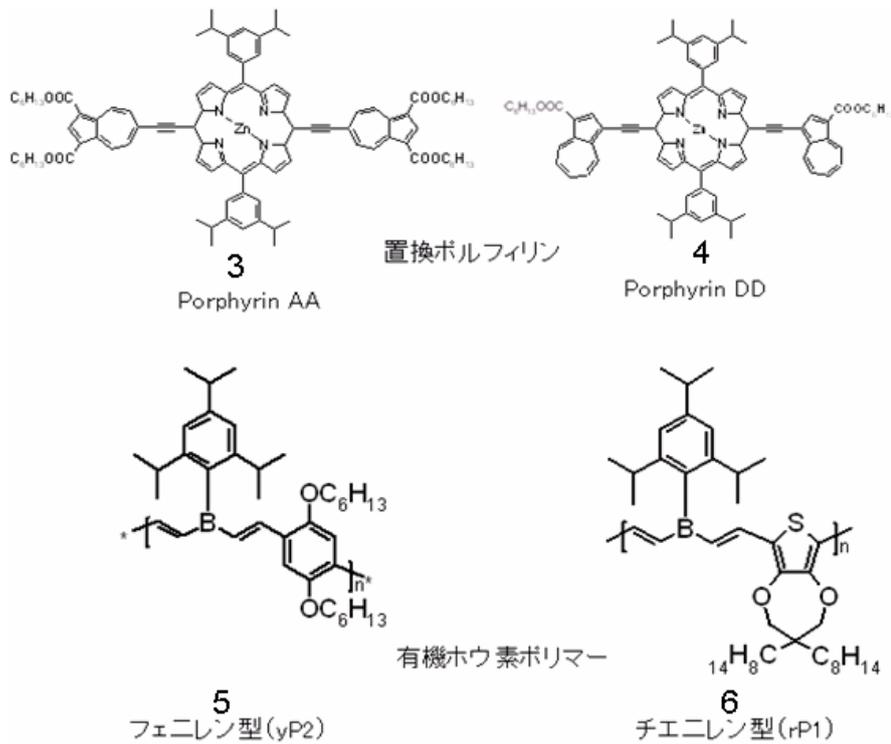
図 2.4.3 新たな分子設計によって合成した二光子吸収材料の分子構造
