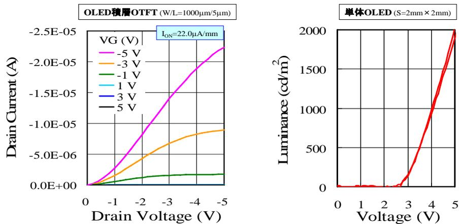
図2. 5. 9. コンポジット基板上の Q-OLET、OLED 特性
