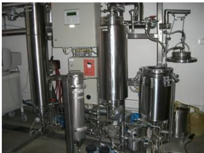
木材蒸解装置：新たに木材蒸解方法をセルロースナノファイバー製造やヘミセルロース・リグニン抽出の観点から開発する。
