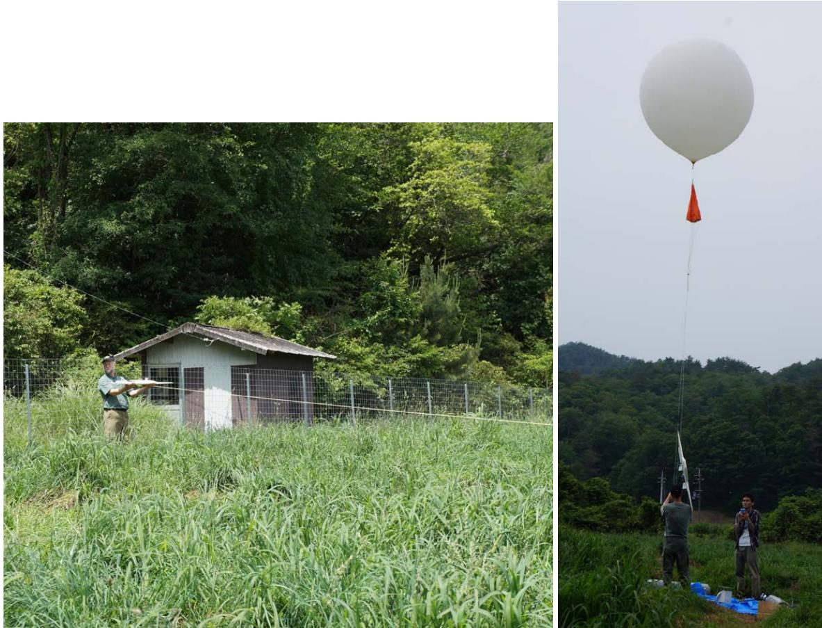
図 1. UAV の離陸の様子。(左)Bungee 法。(右)Balloon 法。
