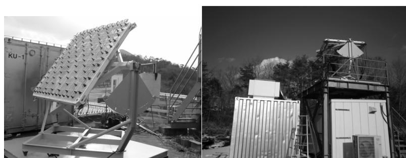
図1: 傾斜型ウインドプロファイラー観測システム
