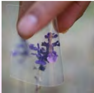
CNF強化低熱膨張透明シート
