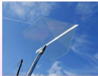
CNF強化低熱膨張透明シート
