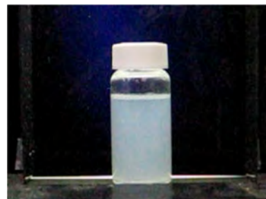
ホヤ外套膜セルロースから65%硫酸加水分解で得たCNC懸濁液の流動複屈折
