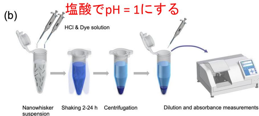
(b) pH = 1（0.1 M HCl）下の測定
