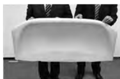
トランクリッド アッパー (100% CNF成形)
