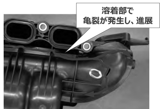
PA6-CNF15破壊後品外観
