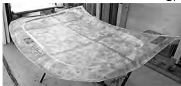
エンジンフード (ボンネット) (CNF + エポキシ樹脂)
