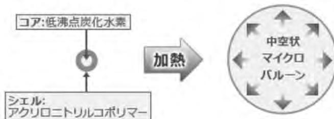
◇使用した熱膨張性マイクロカプセル
