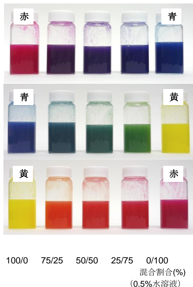
図 93 染色 CNF 水分散液の混合
