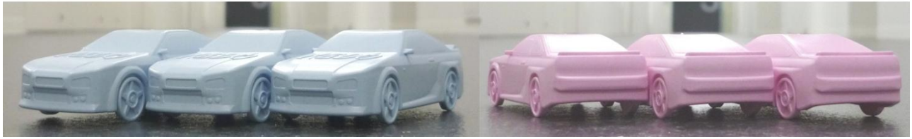
図 99 染色 CNF 射出成形体（ミニカー）
