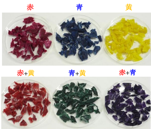
図 96 染色 CNF/PP 複合材料の色調
