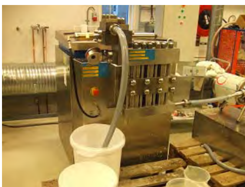
高圧ホモジナイザSPX製(デンマーク) 処理量: 200g/hで濃度1%
