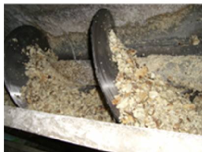
写真4 キャッサバデンプンの抽出プロセス
