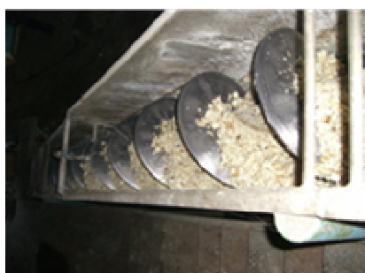
写真4 キャッサバデンプンの抽出プロセス
