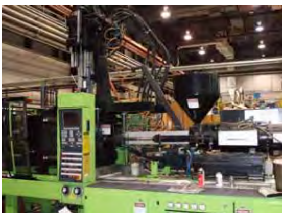
写真 6 型締圧 120t の射出成形機
