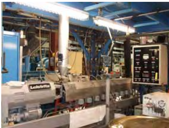
写真 4 軸径 45 の 2 軸混練機
