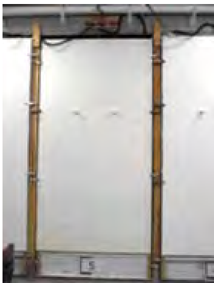
写真 4 暴露試験中の壁材
