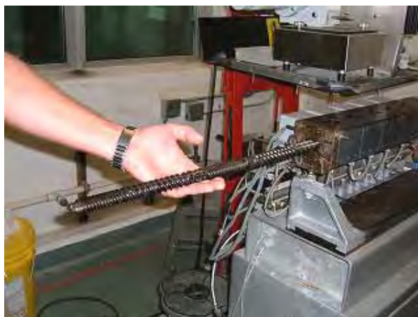
写真 3 ナノファイバー分散用小型 2 軸押し出し機
