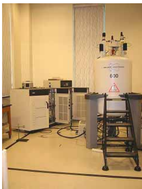
写真 5 分子構造解析用 600G 型 NMR
