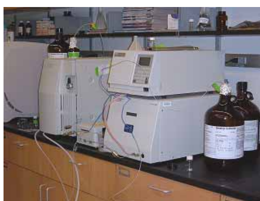
写真 4 分子量分析用ゲルパーミエーション クロマトグラフィ (GPC)
