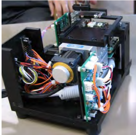
図2. 5. 11. 試作ドライブ装置(一括光再生方式、サイズ:150X100X100mm 3 )
