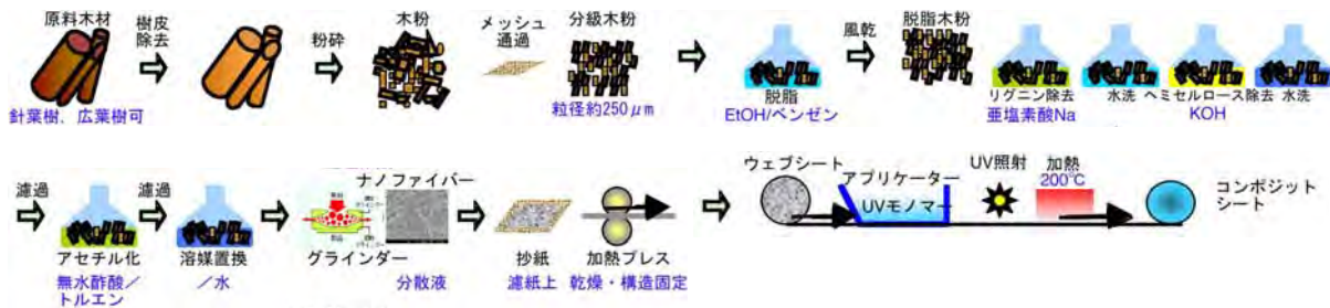
図 1.8 木材からのナノファイバー製造プロセス
