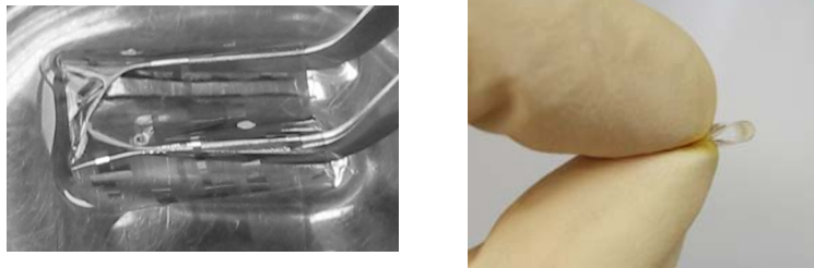
図 2.(2.2).9 超薄膜基板上に形成した有機トランジスタ
