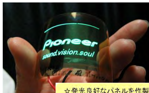
図 1.9 木粉由来のナノファイバーを用いた超フレキシブル有機EL素子基板
