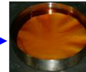
フェノール樹脂注入
