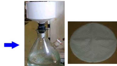
減圧濾過・シート化
