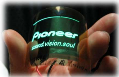
試作の様子 (パイオニア㈱提供) 曲がる有機ELディスプレイ
