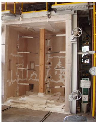
図5 耐火木造柱の耐火実験
