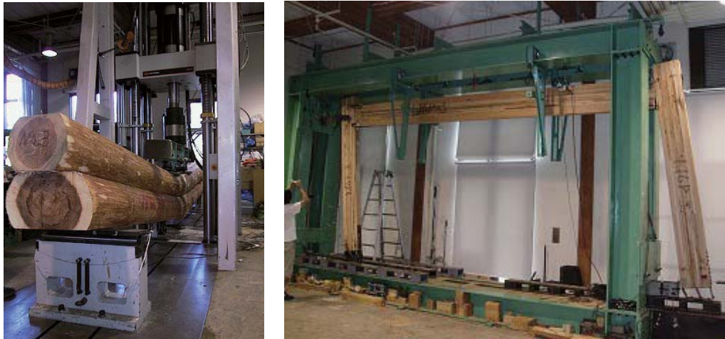
図 2.8 実大耐力実験装置
