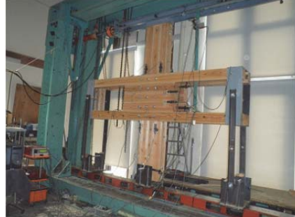
写真5 鋼製反力フレーム
