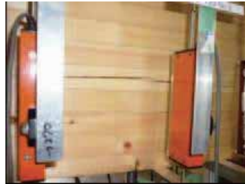
写真7 割裂破壊の様子
