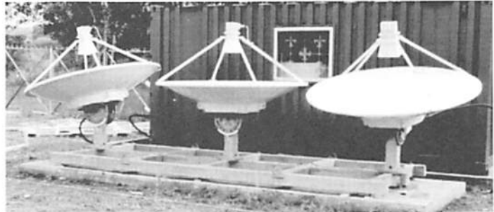
図1: インドネシア共和国スルボンに設置されているLバンド境界層レーダー1号機(三菱電機(株)との協同開発)
