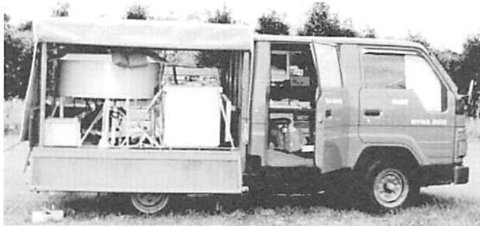
図 3: 車載型 S バンド境界層レーダー (住友電気工業 (株) との協同開発)
