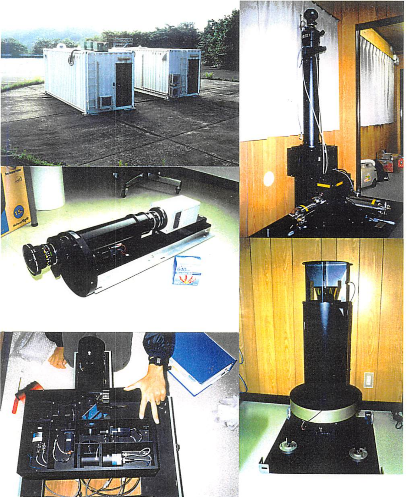
図2：信楽MU観測所に設置された超高層大気イメージングシステム（OMTI）と、その校正機器の写真。左上から反時計回りに、2台のコンテナハウス、全天カメラ、掃天フォトメータ、分光温度計（SATI）、ファブリ・ペロー分光器（左上）。
