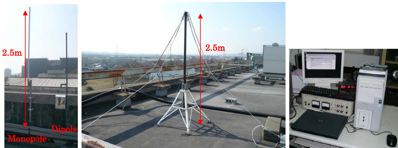
図3. 観測システムの写真。(左) モノポールアンテナおよびダイポールアンテナ。(中) 直交ループアンテナ。(右) データ記録系
