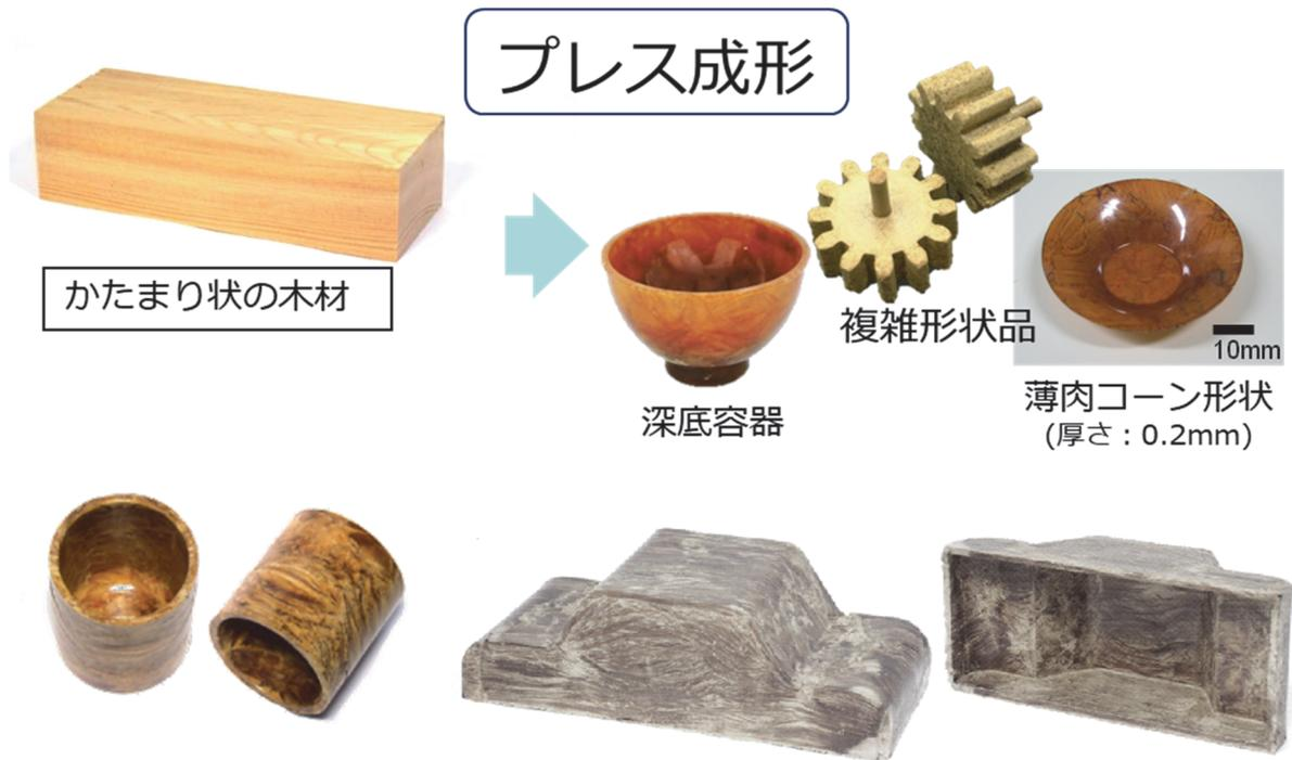
図3：バルク木材からの流動成形の例
