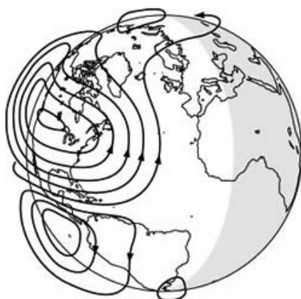
図 6： 地磁気日変化のグローバルな電離圏電流 9) 。電流の流れる方向を矢印で示している。
