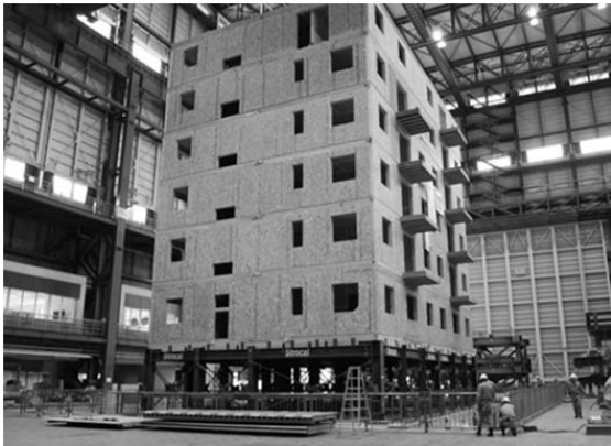
図7 7階建ての震動台実験 5)
