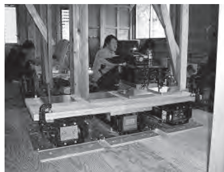
写真8 小型起震機によるエコ住宅の振動性能実験
