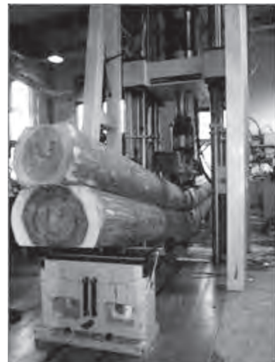
写真4 1,000 kN 堅型サーボアクチュエーター試験機を用いた京都府木橋用スギ丸太2層接着重ね梁の曲げ破壊実験の様子
