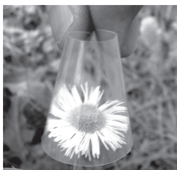
図 7 セルロースナノファイバー補強透明材料 (左) とセルロースナノコンポジットを透明基板に用いた有機 EL 発光素子 (右)
