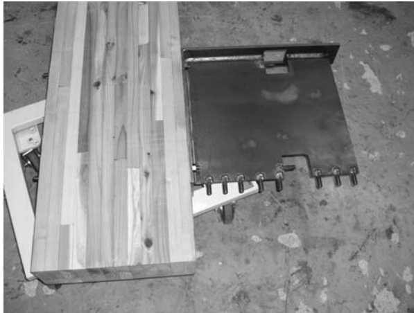
(a) 柱-梁接合部の取り付け状況
