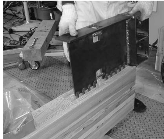
(b) 柱脚接合部の取り付け状況
