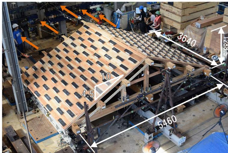
図2 試験体セットアップ
