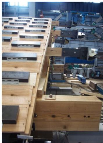
(a) 野地板のずれと垂木のねじれ
