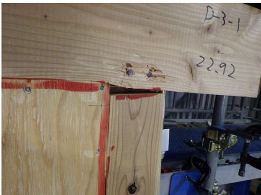
桁側の面材のめり込み
