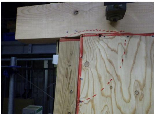
桁側の面材のめり込み
