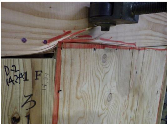
桁側の面材のめり込み
