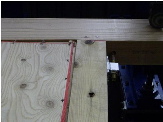
桁側の面材の変形
