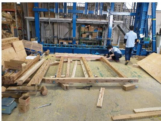
試験体の施工（軸組の組み立て）
