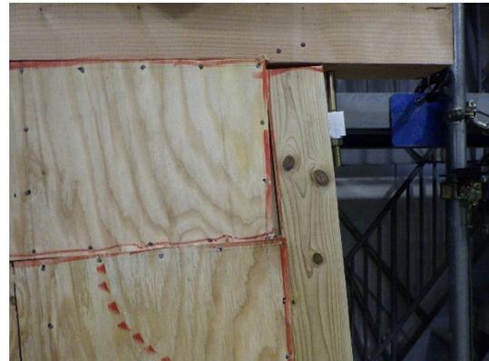
桁側の面材のめり込み
