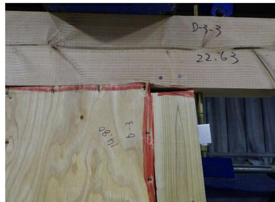
桁側の面材のめり込み
