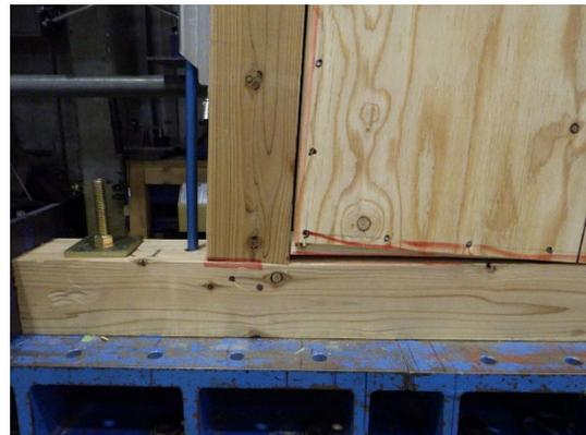
土台側面材くぎの引き抜け
