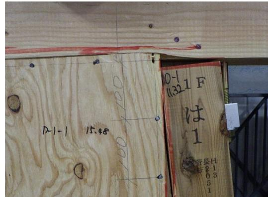
桁側の面材のめり込み
