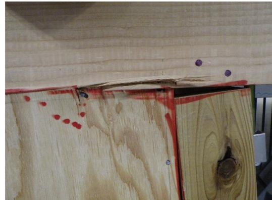
桁側の面材のめり込み
