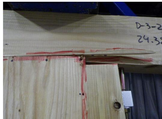
桁側の面材のめり込み
