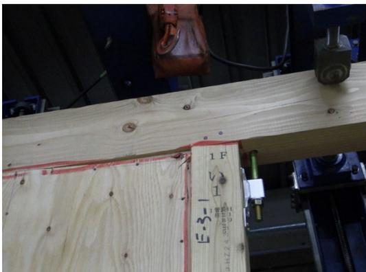
桁側の面材くぎの引き抜け
