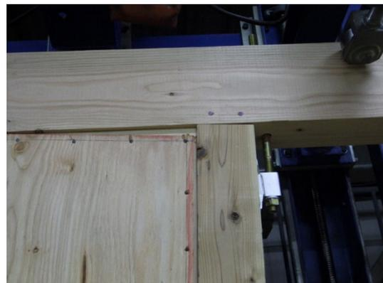
桁側の面材くぎの引き抜け
