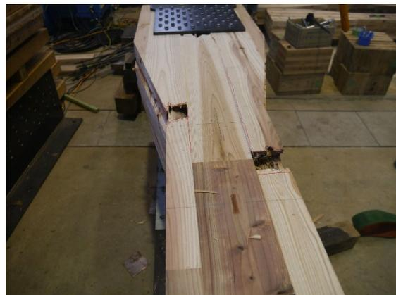
写真 3.3.2-3 No.3 破壊の様子
