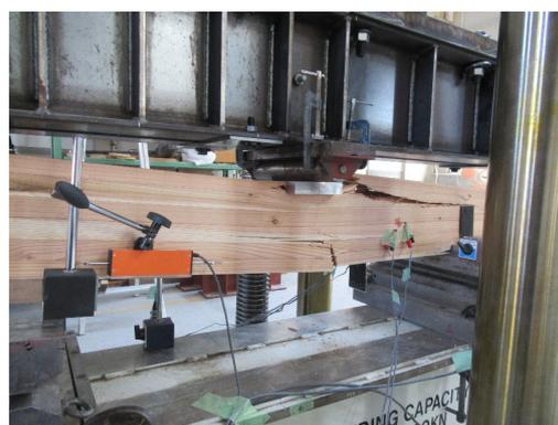
写真 5.3.5-1 アラミド繊維補強無の破壊性状
