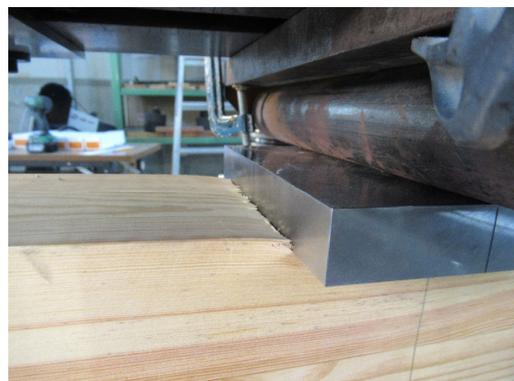
写真 5.3.3-2 L-2 の破壊性状 (左：せん断破壊、 右：めり込み)
