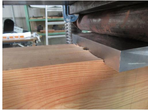
写真 5.3.3-1 L-1 の破壊性状 (左：せん断破壊、 右：めり込み)
