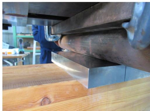
写真 5.3.3-3 L-3 の破壊性状 (左：せん断破壊、 右：めり込み)
