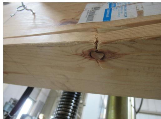
写真 5.3.2-1 繊維平行方向試験体 (3 点曲げ) の曲げ破壊性状
