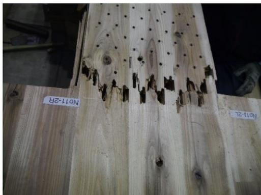
油圧ジャッキ先端部分での CLT の破断
