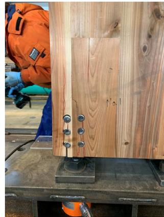
No.1 の破壊性状（側面部の破壊なし）
