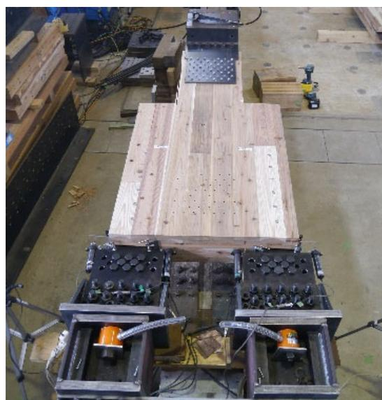
写真 4.2.1-4 接合部を切断し使用した試験体
