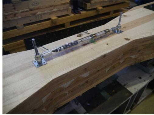
写真 3.3.1-2 変位計、ひずみゲージ
