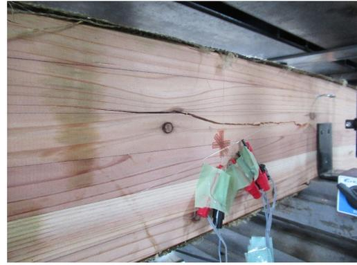
写真 5.3.5-2 アラミド繊維補強有の破壊性状
