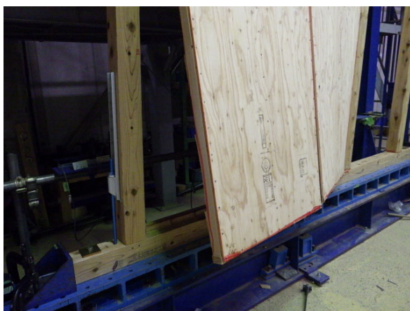
受材の割れによる変形
