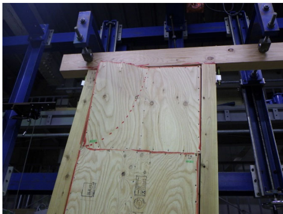
桁側、面材同士の状況
