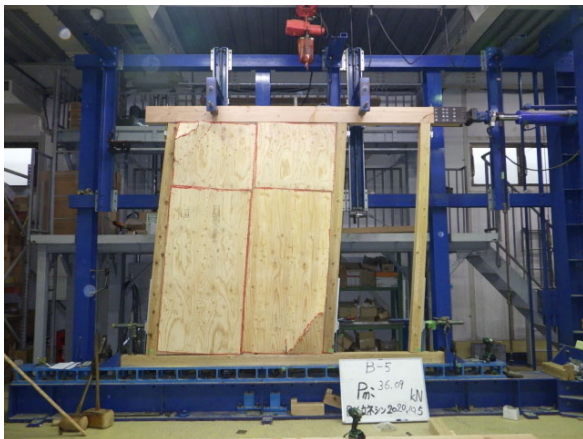
桁側・土台側の面材の座屈（例：B-5 1/13rad 時）
