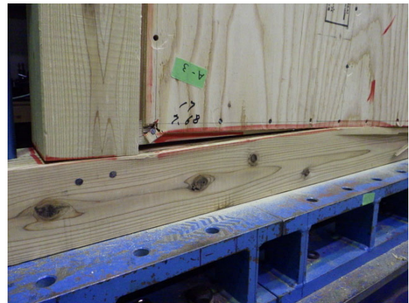
土台と受材の変形
