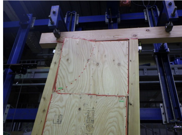
桁側の面材の座屈（例：B-3-1 1/12.5rad 時）
