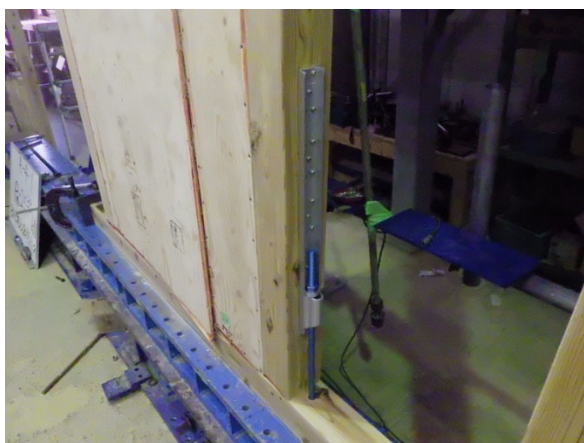
面材の面外への変形
