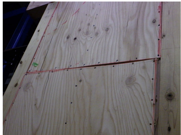
面材と面材の接触（例：A-3-1 1/13rad 時）
