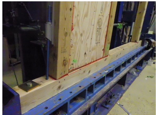
面材の状況（例：B-2-1 1/15rad 時）
