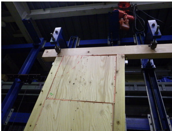
面材と桁の接触（例：A-3-1 1/13rad 時）
