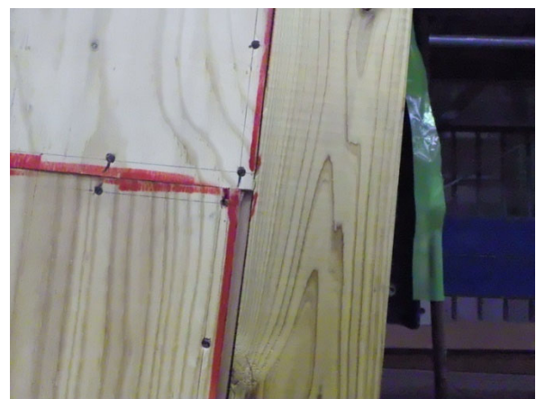
1/15rad 面材の状況
