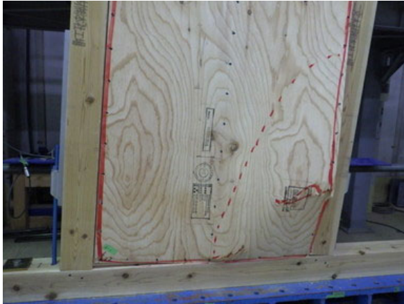
土台側の面材の座屈（例：B-1-1 1/15rad 時）
