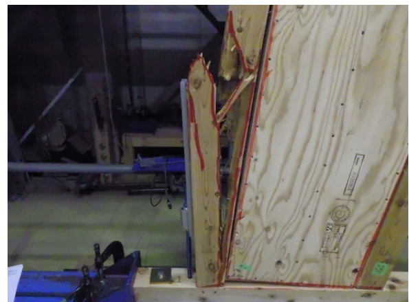
最終変形時の柱の破壊
