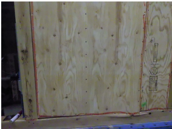
面材と土台の接触（例：A-4-3 1/14rad 時）
