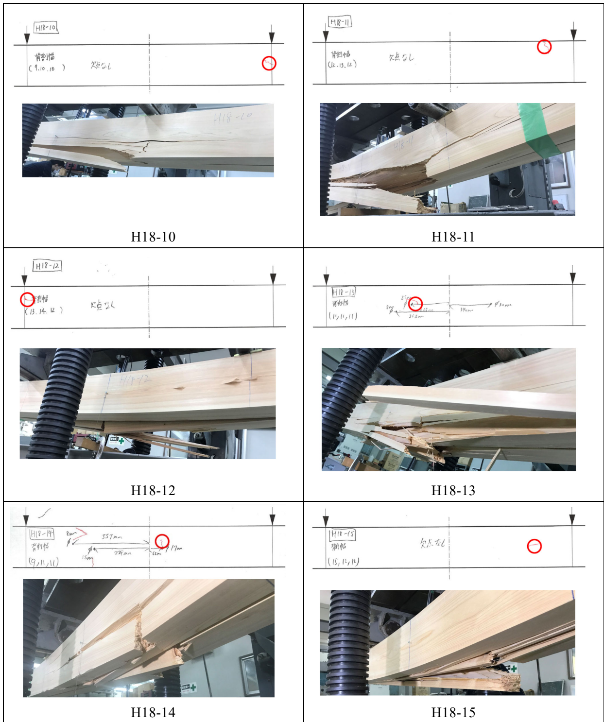
図 3.5-11 欠点計測記録と破壊性状 ((ヒノキ 180 角、4 点曲げ) -2
