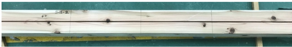
図 3.2.2-1 試験体の面の定義と背割り
