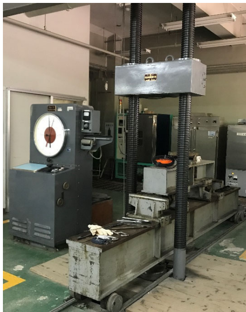
写真 3.3.2-1 曲げ試験装置
