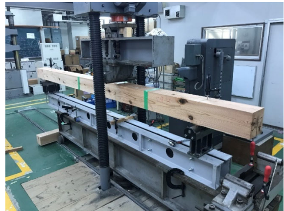
写真 3.3.4-2 3点曲げ試験体の全景
