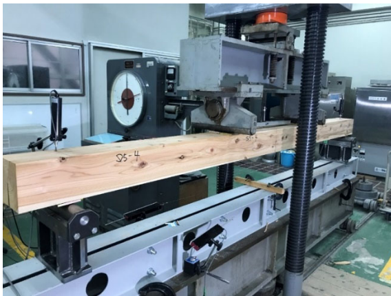
写真 3.3.4-1 4点曲げ試験体の全景
