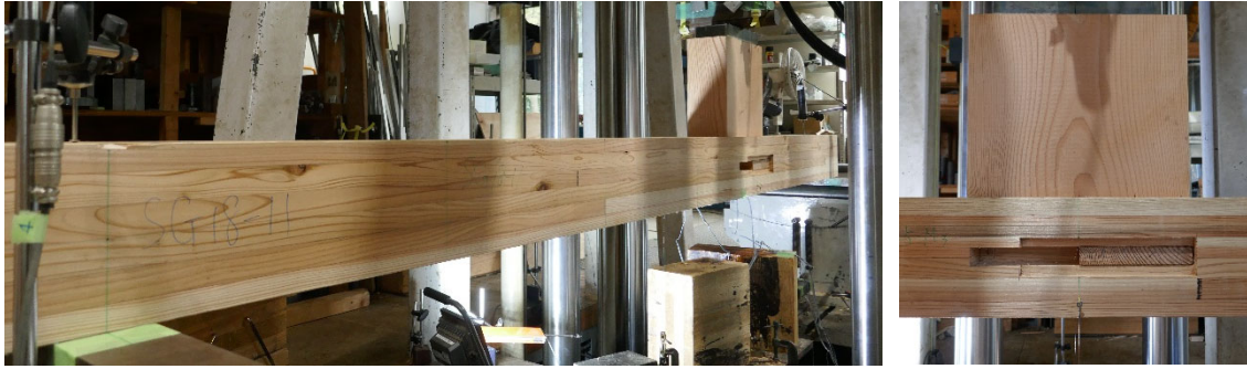
(a) 試験①：仕口有 3点曲げ
