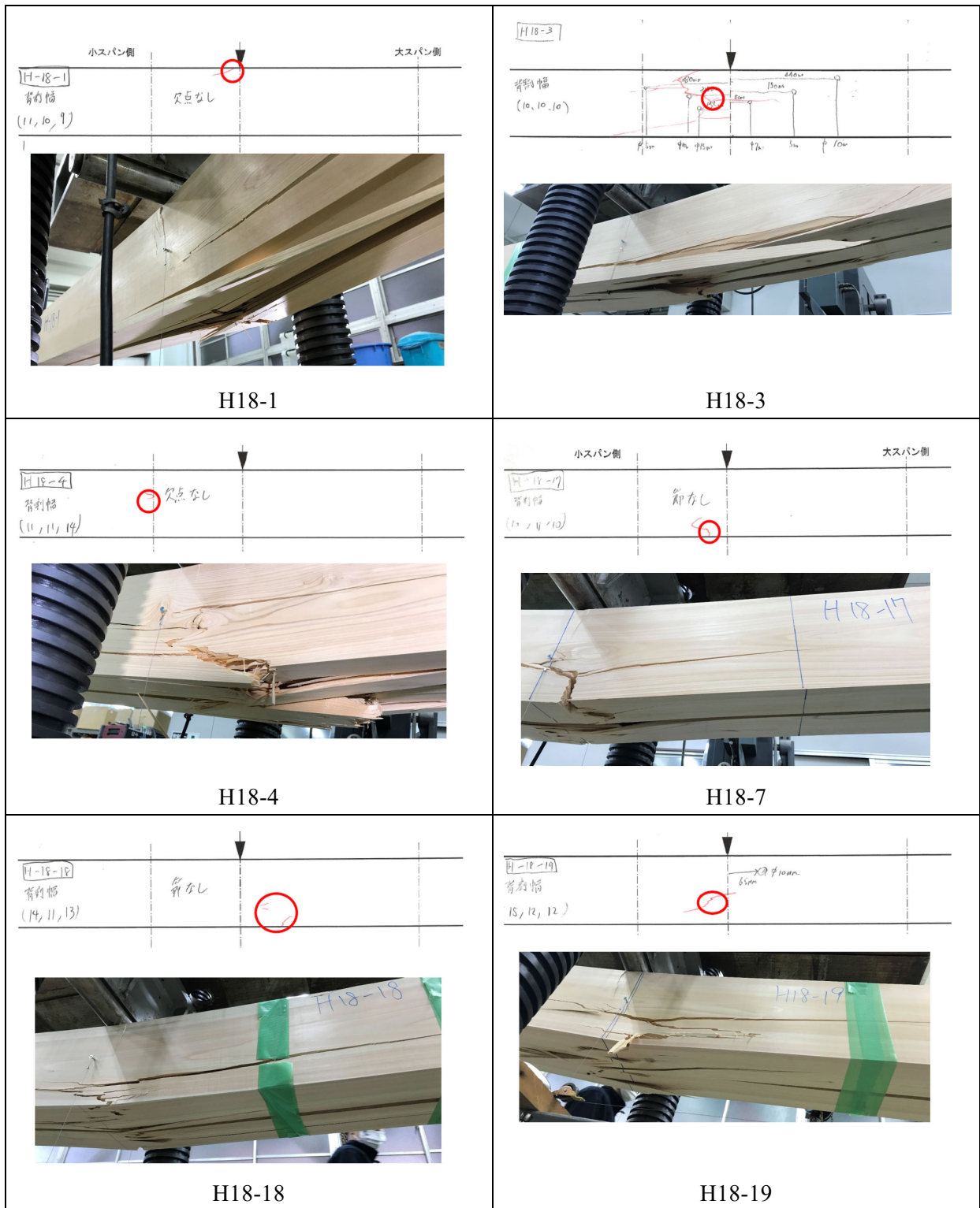
図 3.5-22 欠点計測記録と破壊性状 ((ヒノキ 180 角、3 点曲げ) -1
