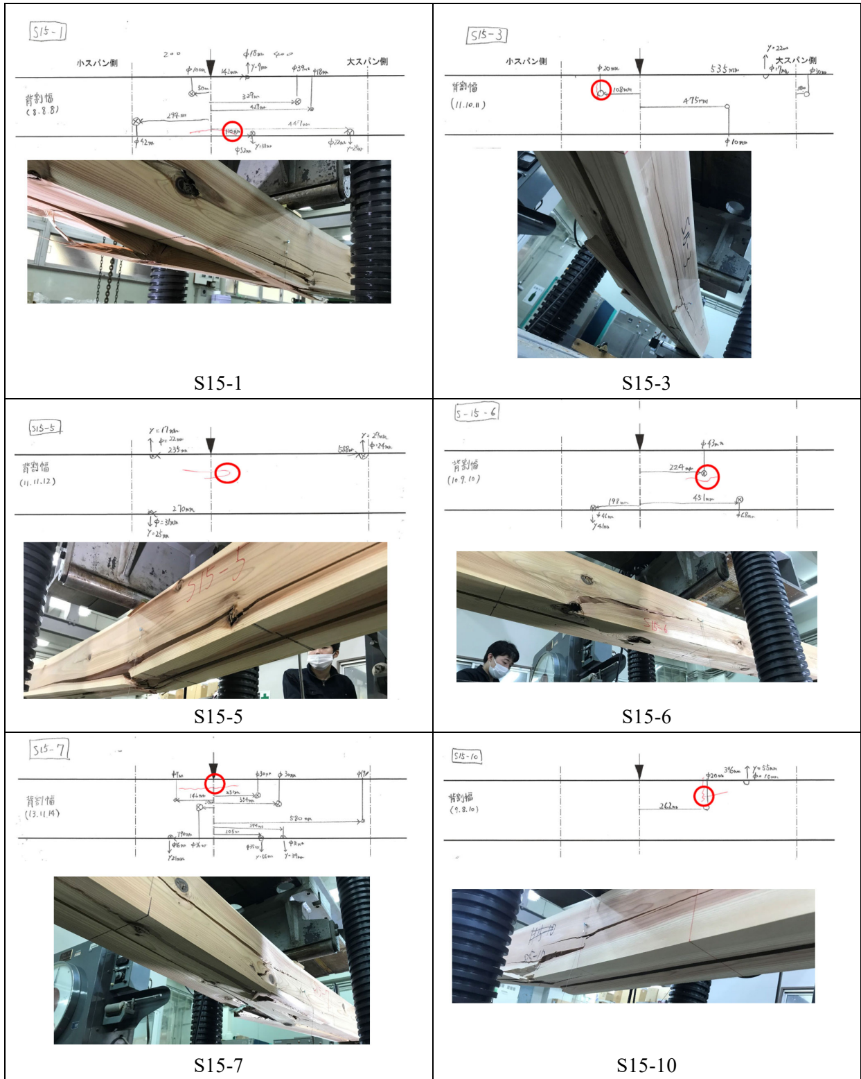
図 3.5-13 欠点計測記録と破壊性状 ((スギ 150 角、3 点曲げ) -1
