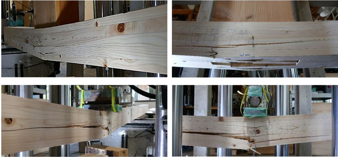
(a) 二方差し試験体（上：仕口有、下：仕口無）
