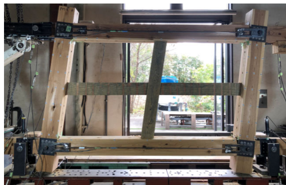
写真 3.2.4-3 軸組のみの抵抗の確認
