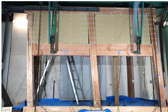
写真 5.2.4-3 FW-L 試験体の大変形時の全体像 (左 : +1/15rad、右 : -1/15rad)
