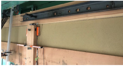
(a) 土壁の回転と梁の浮き上がり
