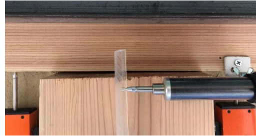
(a) 土壁の回転と梁の浮き上がり
