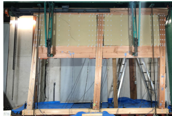
写真 5.2.4-3 FW-L 試験体の大変形時の全体像 (左 : +1/15rad、右 : -1/15rad)
