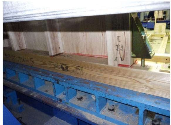
1/15rad 時 柱脚部変形状況
