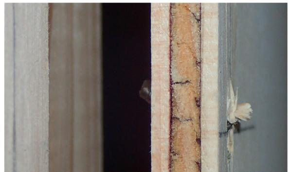
(c) 試験終了後[くぎの破断]
