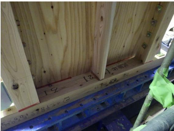
1/15rad 時 柱脚部軸材状況
