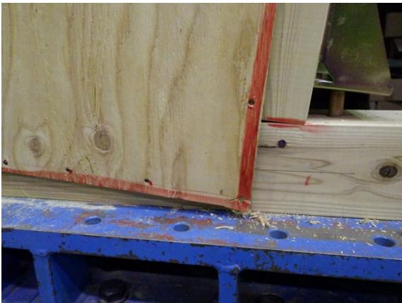
最大変形時 面材変形
