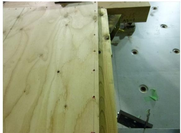
110mm水平変位時くぎ頭の面材へのめり込み
