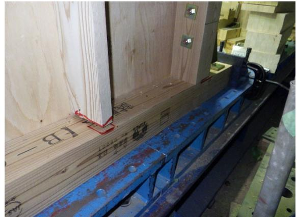
1/15rad 時 柱脚部変形状況
