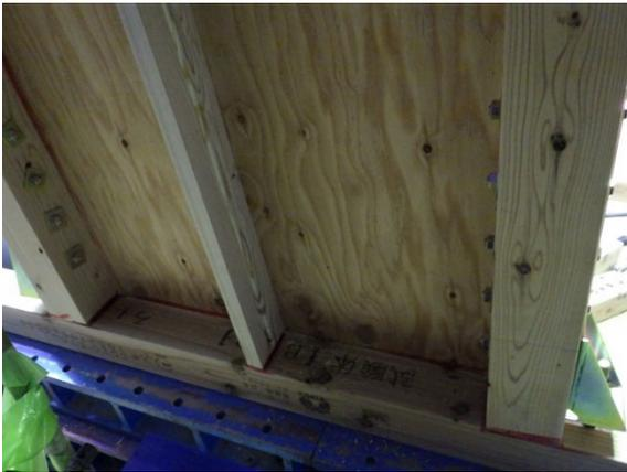
1/15rad 時 柱脚部軸材状況
