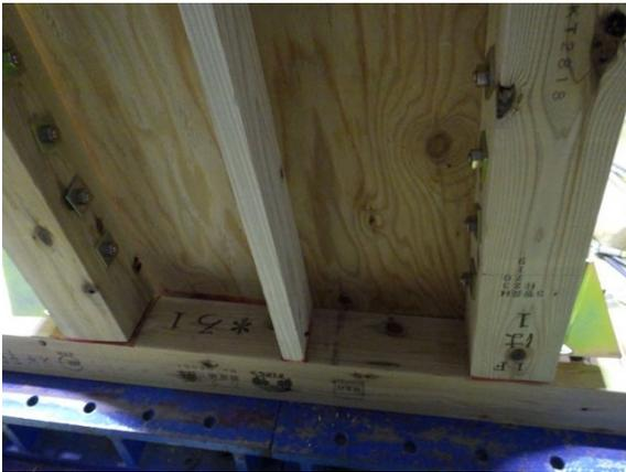
最大変形時 柱脚部軸材状況
