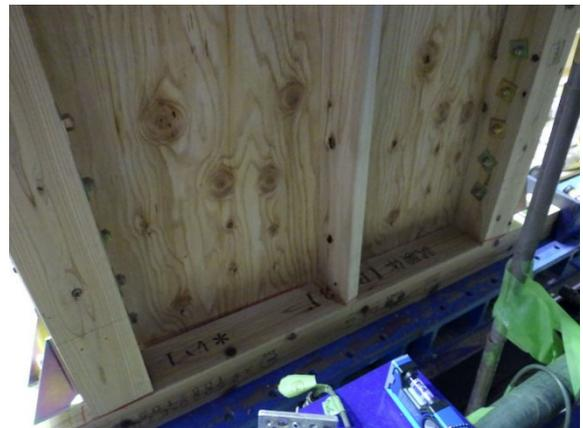
1/15rad 時 柱脚部軸材状況
