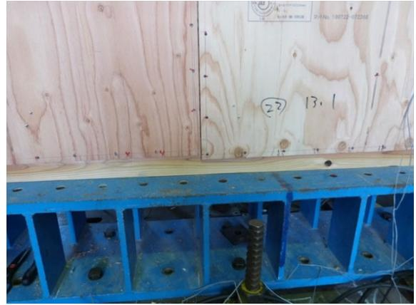
1/50rad 合板継ぎ部の変形
