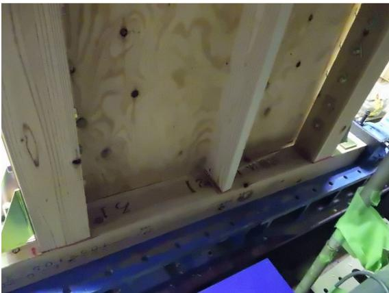
1/15rad時 柱脚部軸材状況
