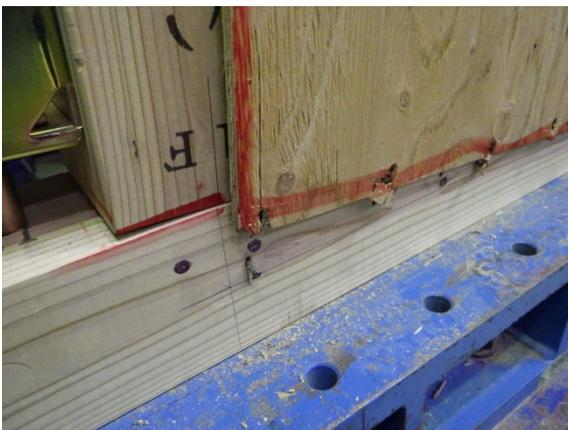
最大変形時 面材変形
