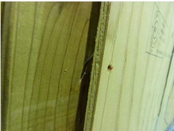
110mm水平変位時くぎのパンチアウト及び抜け
