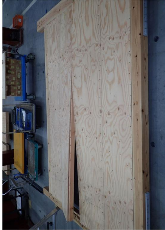
(b) 試験終了後[面材の変形]
