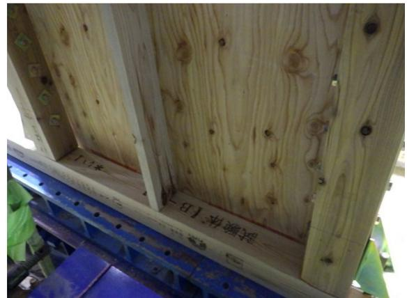
1/15rad 時 柱脚部軸材状況
