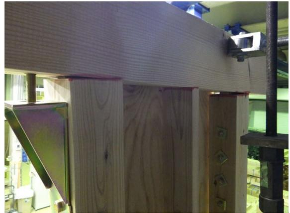
最大変形時 柱頭部軸材状況
