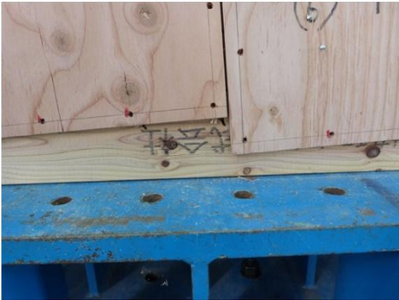
110mm水平変位時 面材継ぎ部状況
