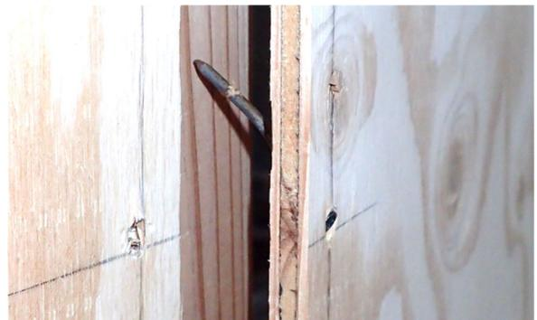
(c) 試験終了後[くぎ軸部抜け出し]
