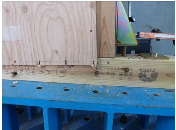
110mm 水平変位時 柱脚部状況
