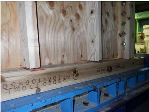
1/15rad 時 柱脚部変形状況
