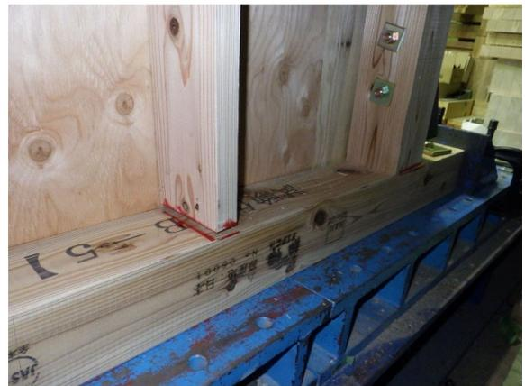
1/15rad 時 柱脚部変形状況
