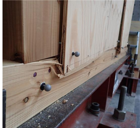
(b) 試験終了後[面材の変形]
