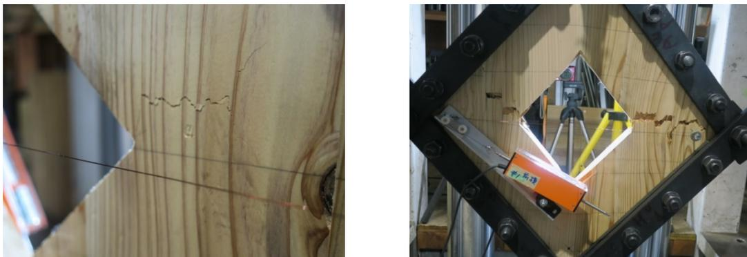
図 3.3.2-2 45 度四角窓 B 試験体の破壊の様子
