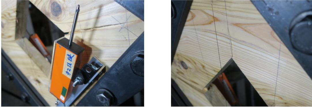
図 3.3.2-1 45 度四角窓 A 試験体の破壊の様子
