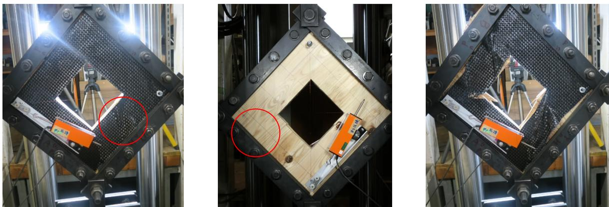
図 3.3.2-3 CF 補強試験体の破壊の様子
