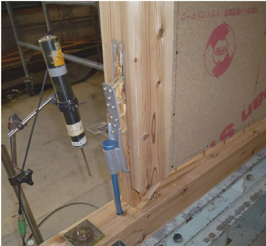
写真 2.2.1-2 B-2-1 の柱脚金物の集合破壊
