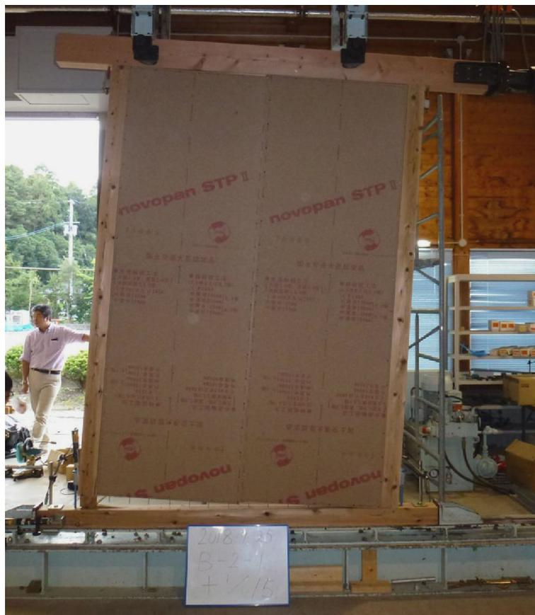
写真 2.2.1-4 B-2-1 の破壊状況
