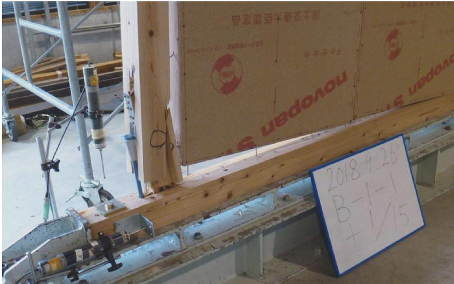
写真 2.2.1-1 B-1-1 の柱脚金物の集合破壊
