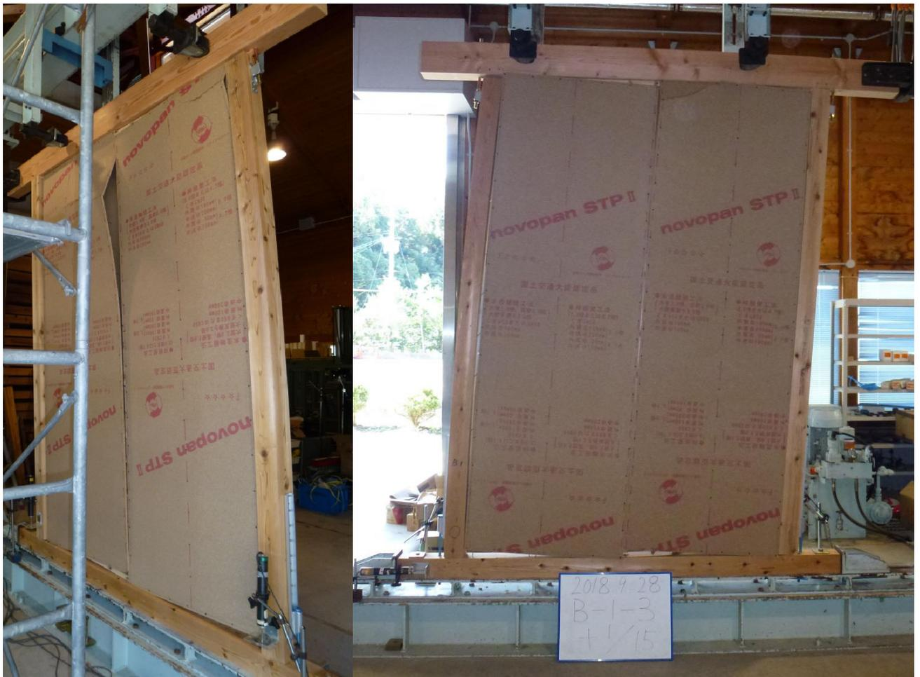
柱脚を変更したため柱脚は破壊せず、最大耐力まで加力可能。
