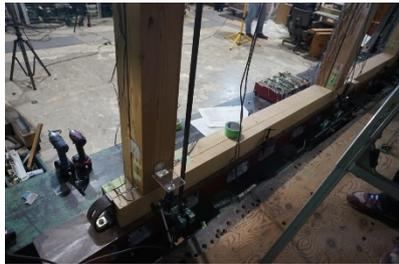
軸組型 (F) 試験体 (柱脚)
