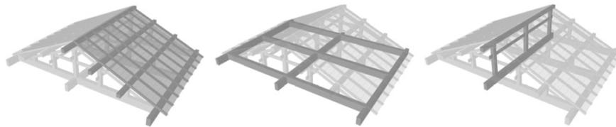
(a) 屋根構面 (b) 小屋ばり構面 (c) 鉛直構面
