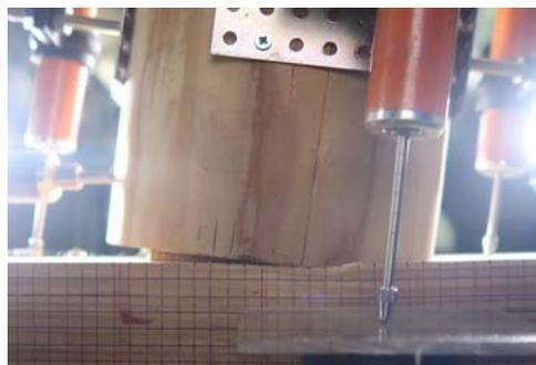
写真 4.4.3-8 終局時の柱頭柱脚の様子 (φ120/横架材あり)
