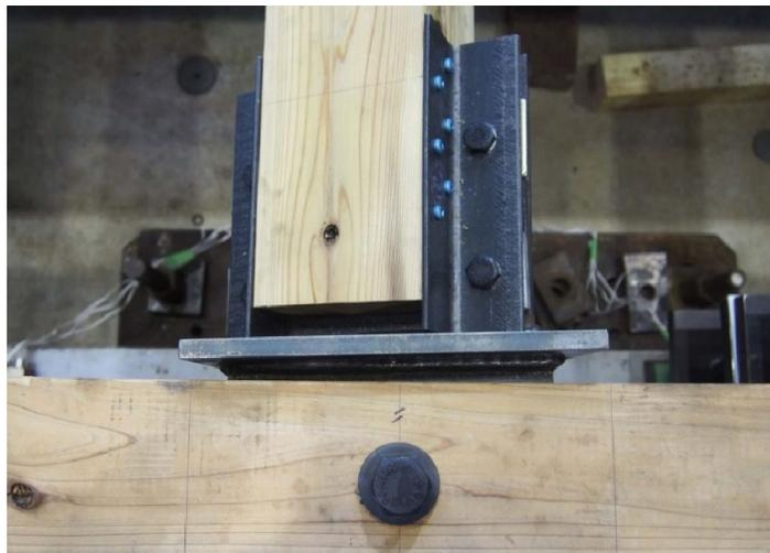
写真 2.2.1-2 載荷用土台－母屋の接合に用いた治具
