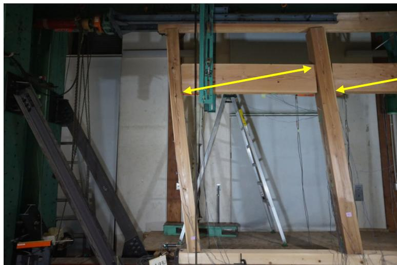
写真 3.4.1-1 大変形時の差鴨居の柱間での突っ張り抵抗の様子
