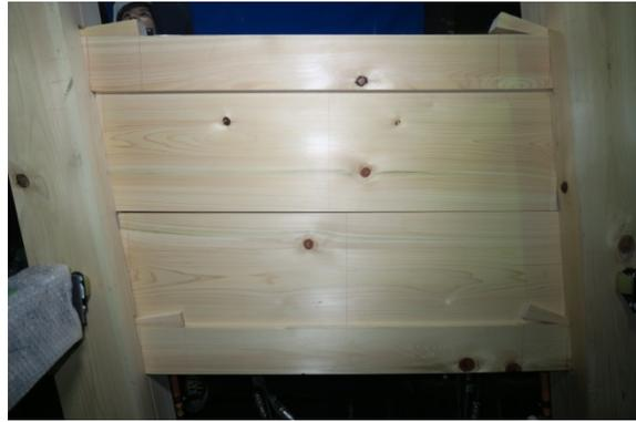
写真 4.4.3-6 終局時の板壁の様子 (低軸力試験体/高軸力試験体)
