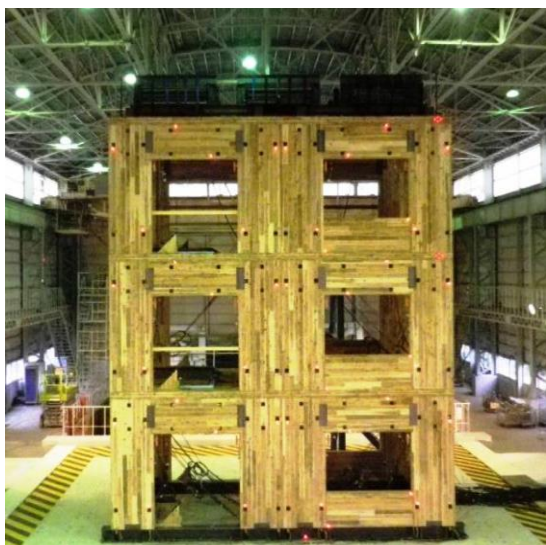
CLTパネル工法
