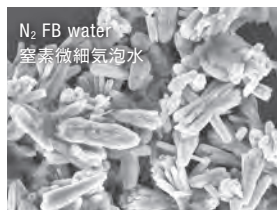
微細気泡の利用(無機化学)——酸化亜鉛のSEM画像 Fine bubble applications (Chemistry) SEM images of ZnO
