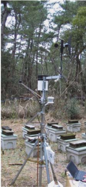
生活・森林圏シミュレーションフィールド (LSF): 左より時計回りに、全自動気象測器、木材・木質材料の防蟻野外試験、シロアリの階級分化に関する国際共同研究
