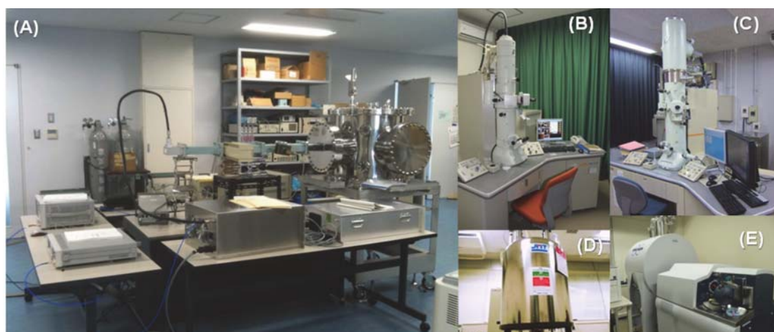
先進素材開発解析システム（ADAM）を構成する主要機器：(A) 高度マイクロ波加熱応用及び解析サブシステム、(B) 有機用透過電子顕微鏡、(C) 無機用電界放出形電子顕微鏡、(D) 多核核磁気共鳴装置、(E) FT-ICR-MS
