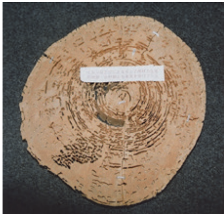
写真1：シロアリ類による針葉樹材（ロシア産カラマツ材）（左）と本の被害（右）。前者ではシロアリによる典型的な同心円状の被害が明瞭である。
