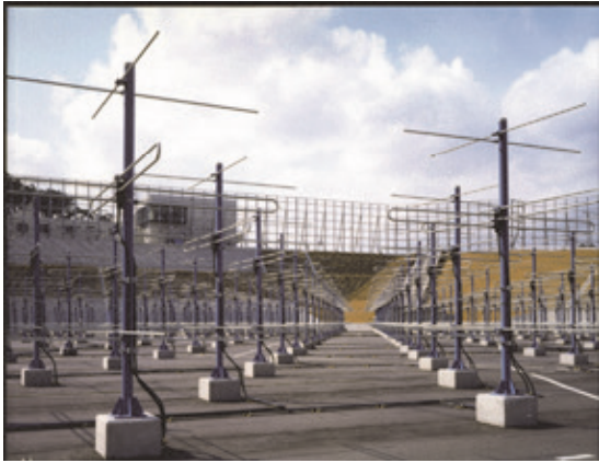
図 3: MU レーダーの直交三素子八木アンテナ
