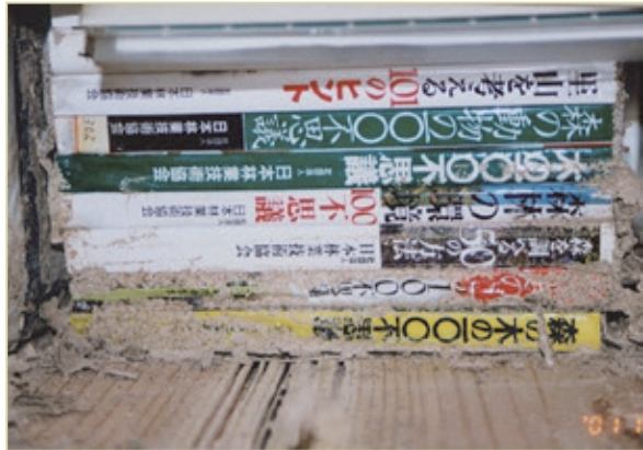
写真1：シロアリ類による針葉樹材（ロシア産カラマツ材）（左）と本の被害（右）。前者ではシロアリによる典型的な同心円状の被害が明瞭である。
