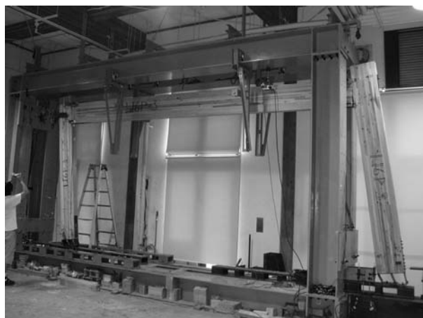
写真 8：スパン 6 m の異樹種集成材門型ラーメン構造の実大加力実験における終局状態
