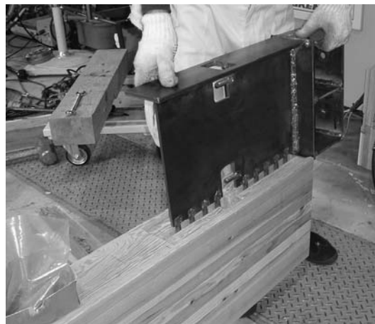
(b) 柱脚接合部の取り付け状況
