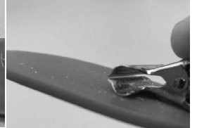
金属目玉クリップとの耐摩耗テスト(50回着脱)で3個体を写真記録
