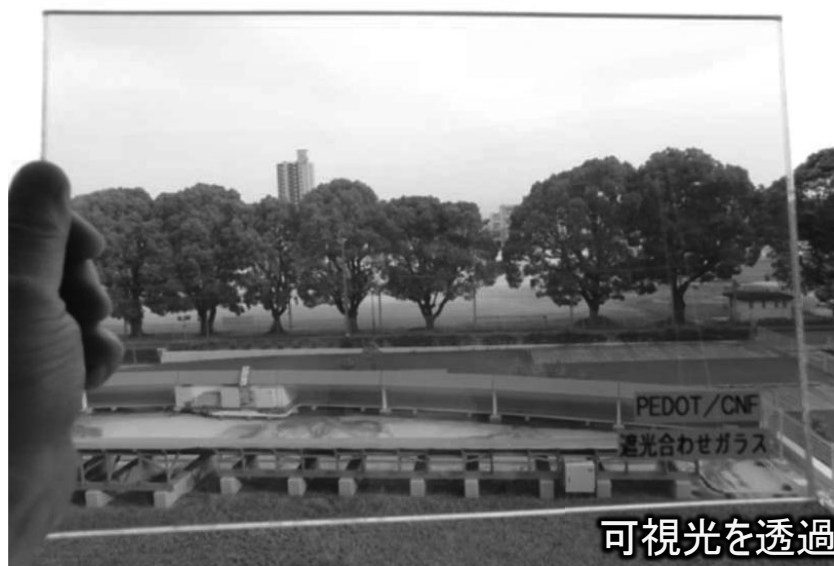
PEDOT/s-CNF-PVAコンポジットフィルムを用いた合わせガラス
