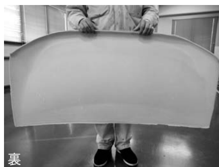
100%CNF製トランクカバー試作品(トヨタ 86)
