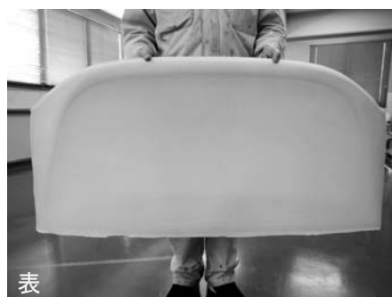
100%CNF製トランクカバー試作品(トヨタ 86)
