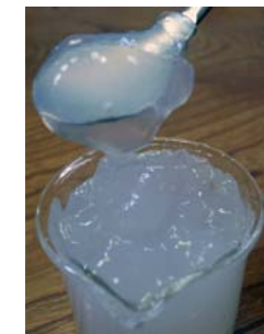
木材から単離した幅15nmのセルロースナノファイバー（左）と1wt%水懸濁液（右）
