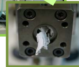
二軸混練機による原料（パルプ） の解繊
