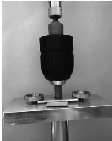
引張試験用治具とテストピース
