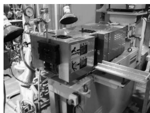
二軸押出機で熔融混練
