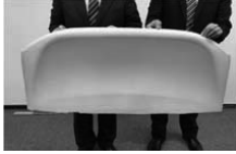
トランクリッド アップパー 100% CNF成形
