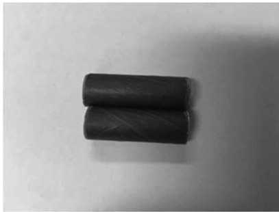
CNFパイプ/CNFパイプ 接着試験用テストピース
