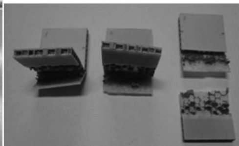
CNF紙/CNF板の破壊状態
