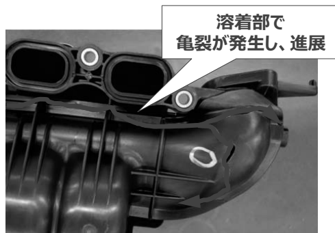
PA6-CNF15破壊後品外観
