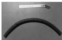
ビーム等補強加工 紙管+CNFシート
