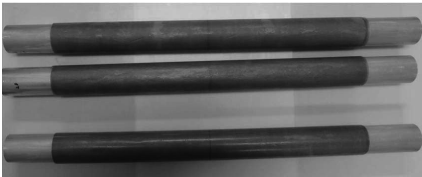
Φ 300mmアルミ/CNFペーパー複合丸パイプ
