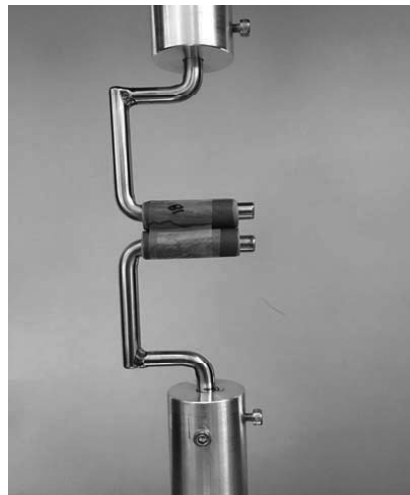
引張試験用治具と テストピース
